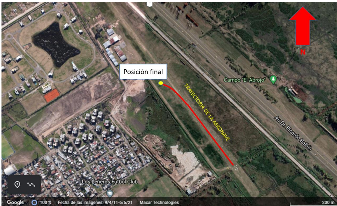
Figura 2. Carrera de despegue y posición final de la aeronave. Fuente: investigación JST
