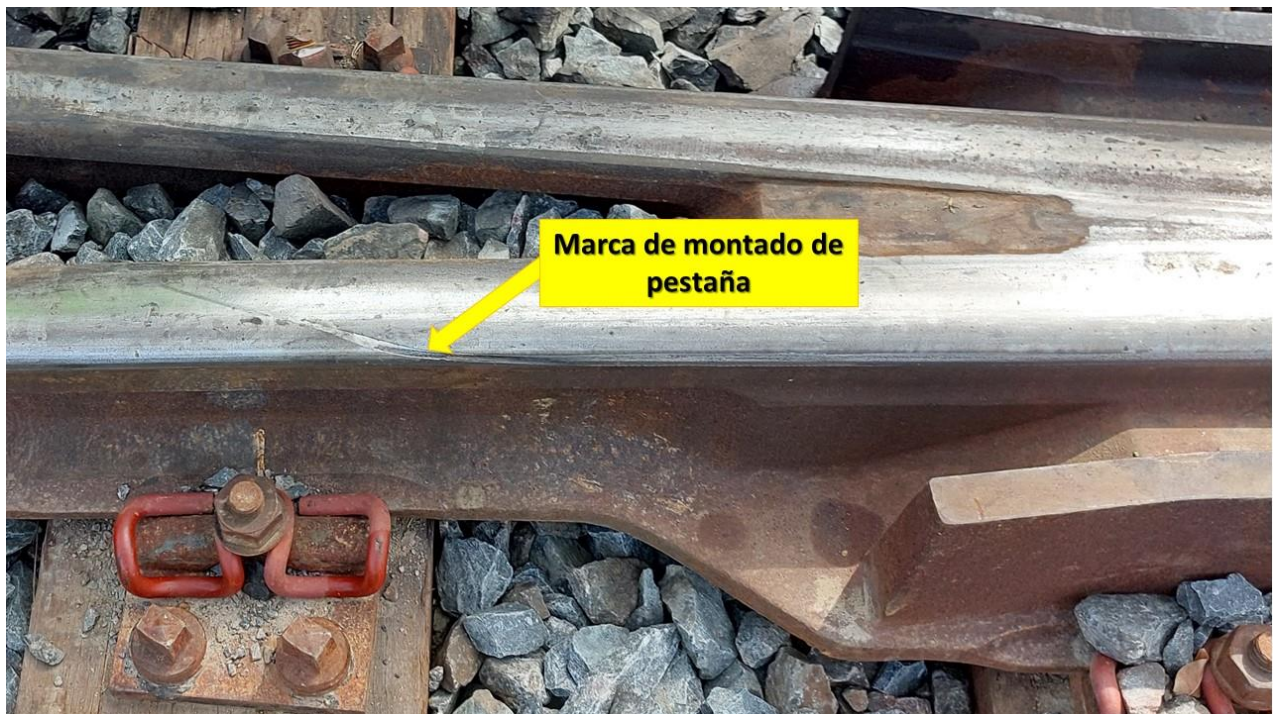
Figura 5. Marca de montado de pestaña sobre el hongo del riel. Fuente: JST, 2022
