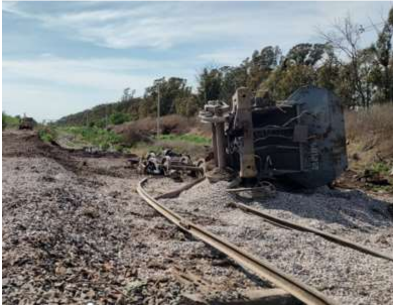
Figura 5. Vagón volcado y boguies desprendidos. Fuente: JST, 2022
