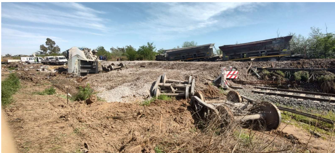
Figura 1. Vagones del tren N°FO4 descarrilados y volcados. Fuente: JST, 2022
