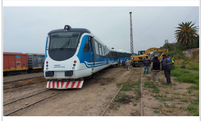
Figura 2. Vista frontal del coche motor descarrilado
