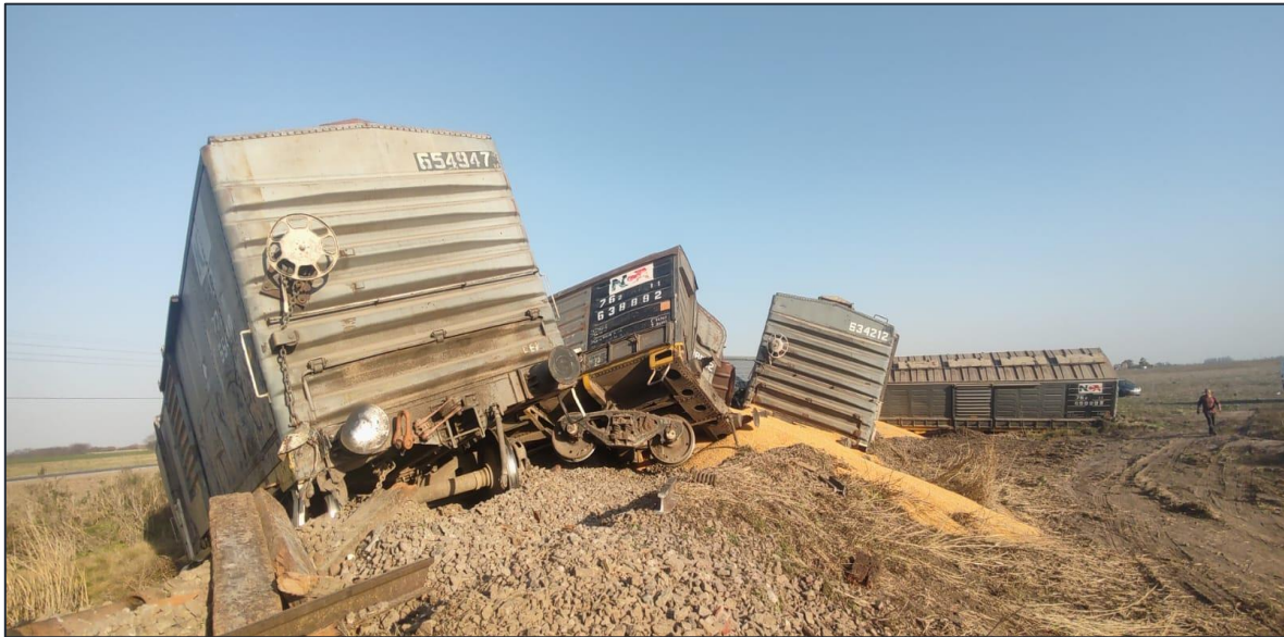
Figura 4. Daños en los bogies y pérdida de carga. Fuente: JST 2023
