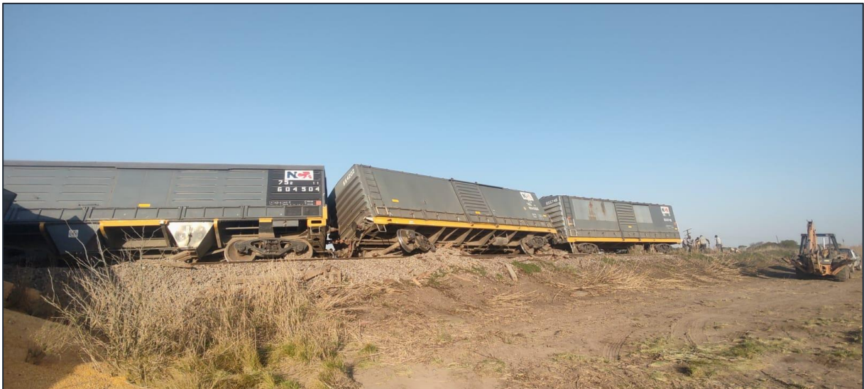
Figura 1. Vagones descarrilados. Fuente: JST 2023
