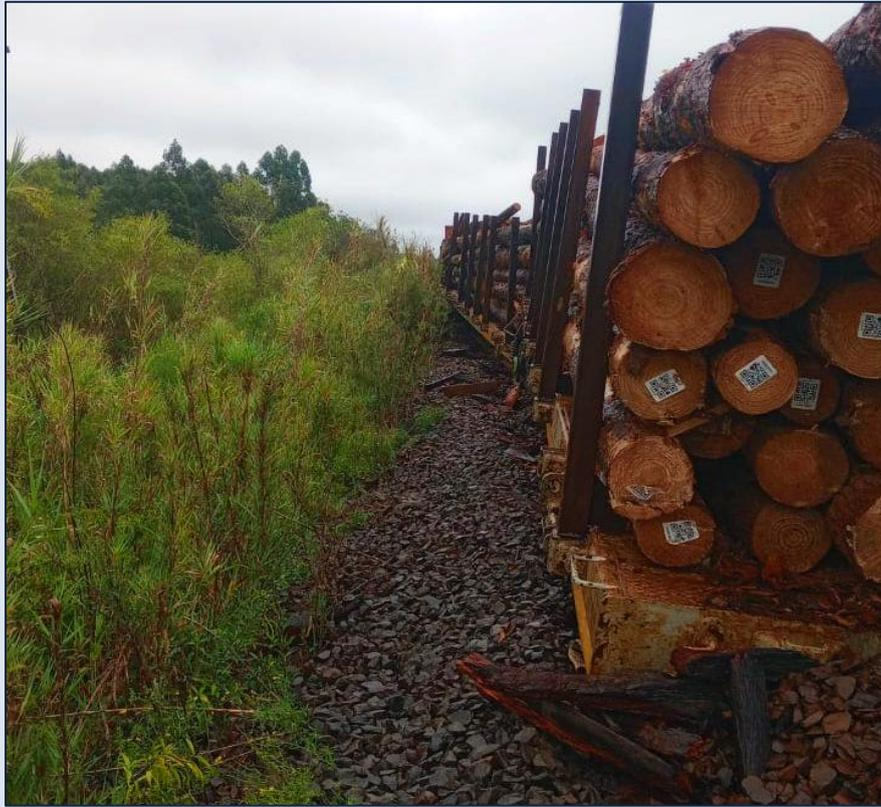
Figura 2. Imagen de los vagones descarrilados cargados con rollizos de madera.
