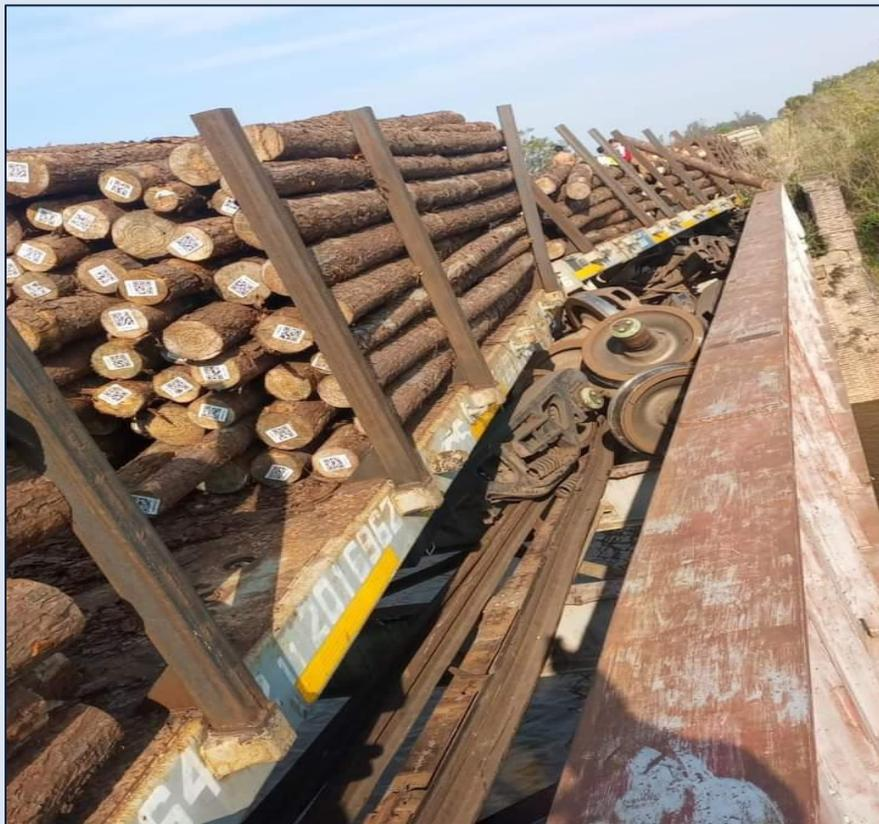
Figura 1. Imagen del descarrilamiento sobre una obra de arte (puente).
