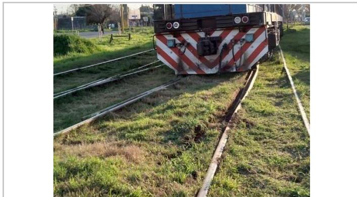
Figura 2. Imagen del riel afectado por el descarrilamiento.
