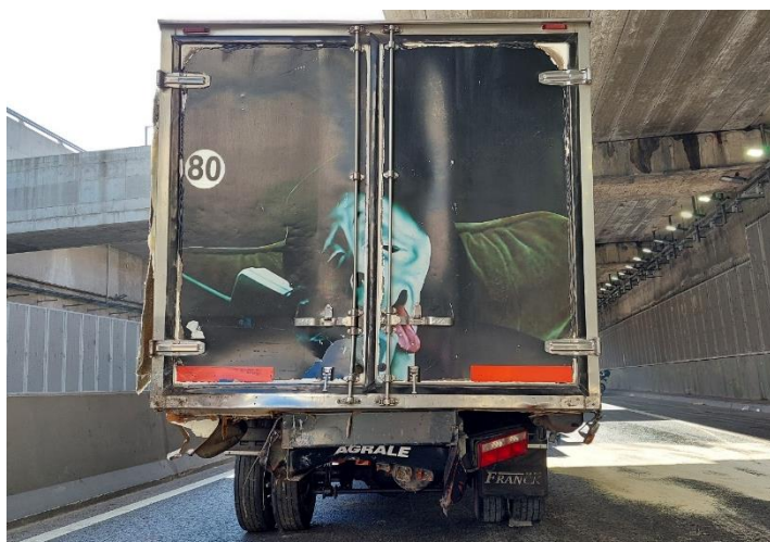
Figura 11. Daños producidos por la colisión con el sector anterior de la unidad tractora del Vehículo 1.
