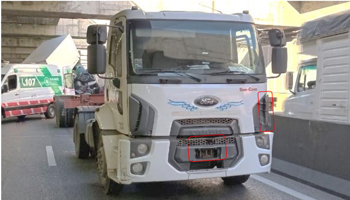
Figura 12. Daños en el sector anterior del Vehículo 3. Fuente: AUSA, 2023
