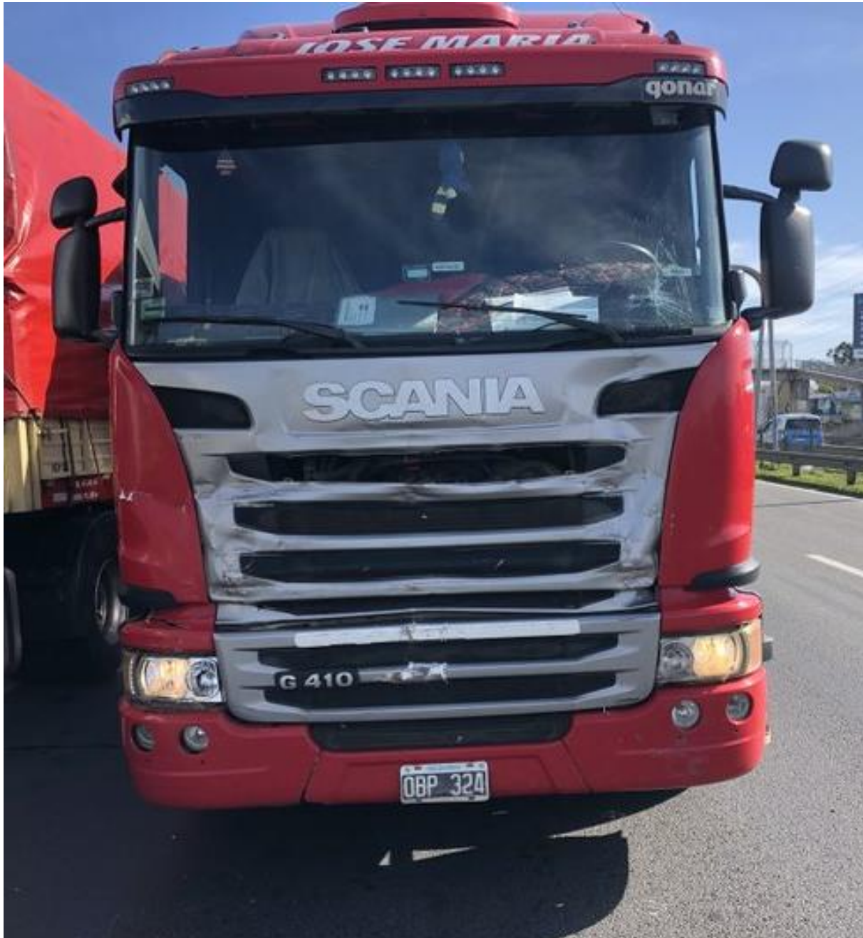
Figura 10. Daños de la unidad tractora del Vehículo 2, ocasionados por la colisión con el semirremolque del Vehículo 1. Fuente: JST, 2023
