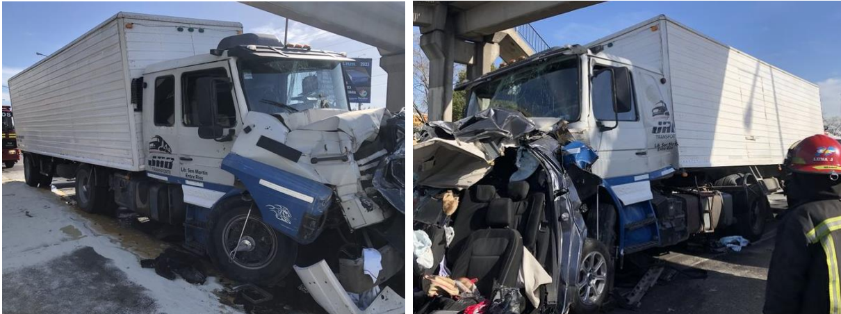
Figura 18. Deformaciones de la unidad tractora del Vehículo 5. Fuente: JST, 2023
