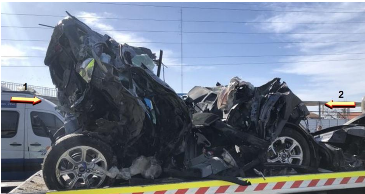
Figura 15. Fotografía donde se ilustra la fuerza (1) que entregó el Vehículo 5 y la fuerza (2) que aplicó el semirremolque del Vehículo 3. Fuente: JST, 2023
