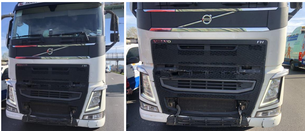
Figura 14. Daños de la unidad tractora del Vehículo 3 que fueron ocasionados por la colisión con el semirremolque del Vehículo 2. Fuente: JST, 2023
