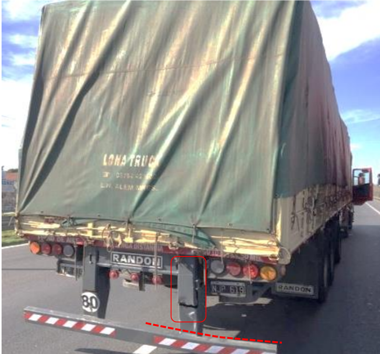
Figura 11. Pliegue del paragolpes y corte de larguero vertical. Fuente: JST, 2023
