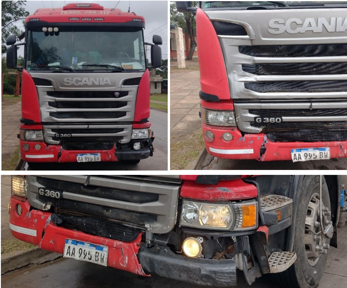
Figura 10. Daños registrados en el Vehículo 1, con detalle del sector frontal izquierdo. Fuente: JST, 2023
