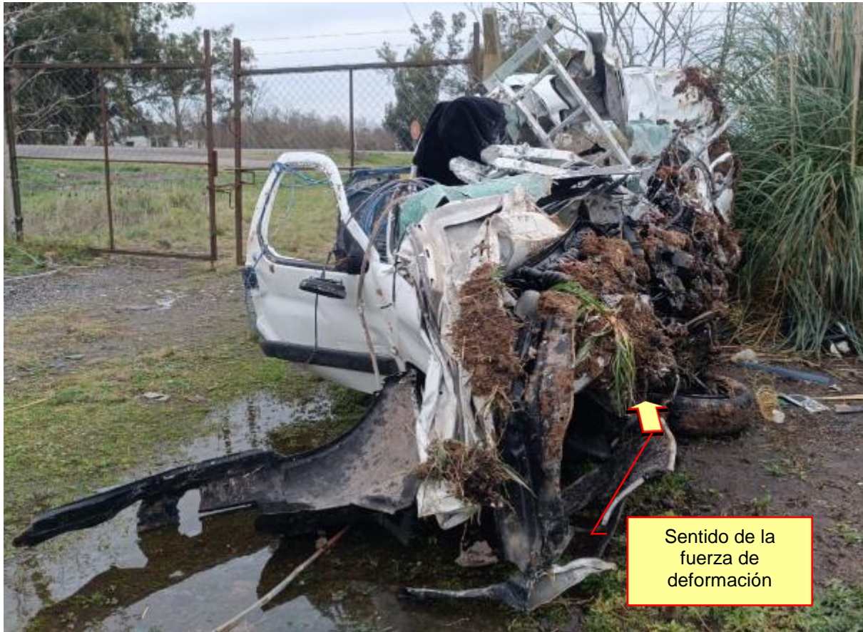
Figura 7. Daños en el sector anterior del Vehículo 1. Fuente: JST, 2023
