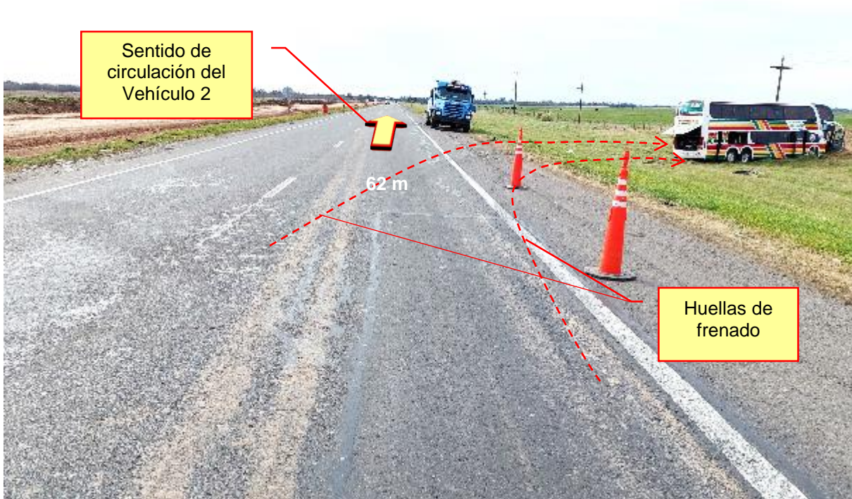
Figura 13. Huellas de frenado que determinan la trayectoria pos colisión del Vehículo 2. Fuente: JST, 2023
