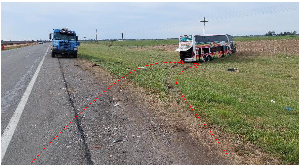
Figura 16. Huellas de frenado pos colisión del Vehículo 2 sobre la zona de préstamo hacia San Miguel del Monte. Fuente: JST, 2023
