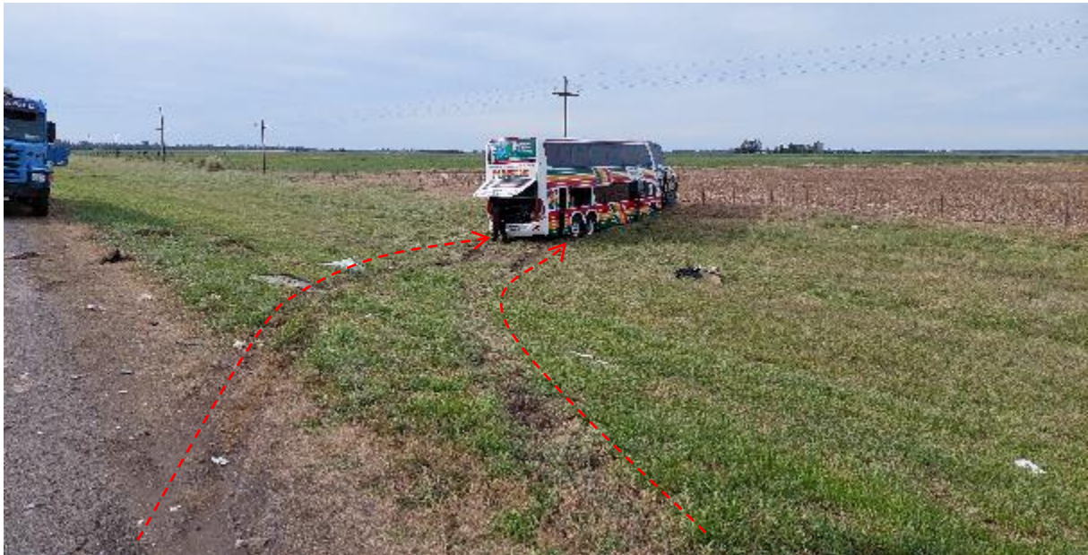
Figura 17. Huellas de frenado pos colisión del Vehículo 2 sobre la pendiente descendente de la zona de préstamo hacia San Miguel del Monte. Fuente: JST, 2023
