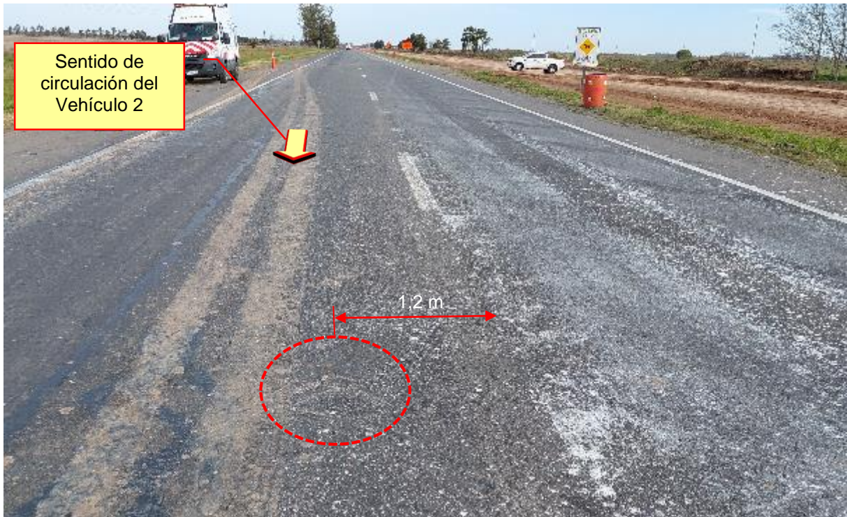
Figura 12. Efracciones que determinaron la zona de colisión. Fuente: JST, 2023
