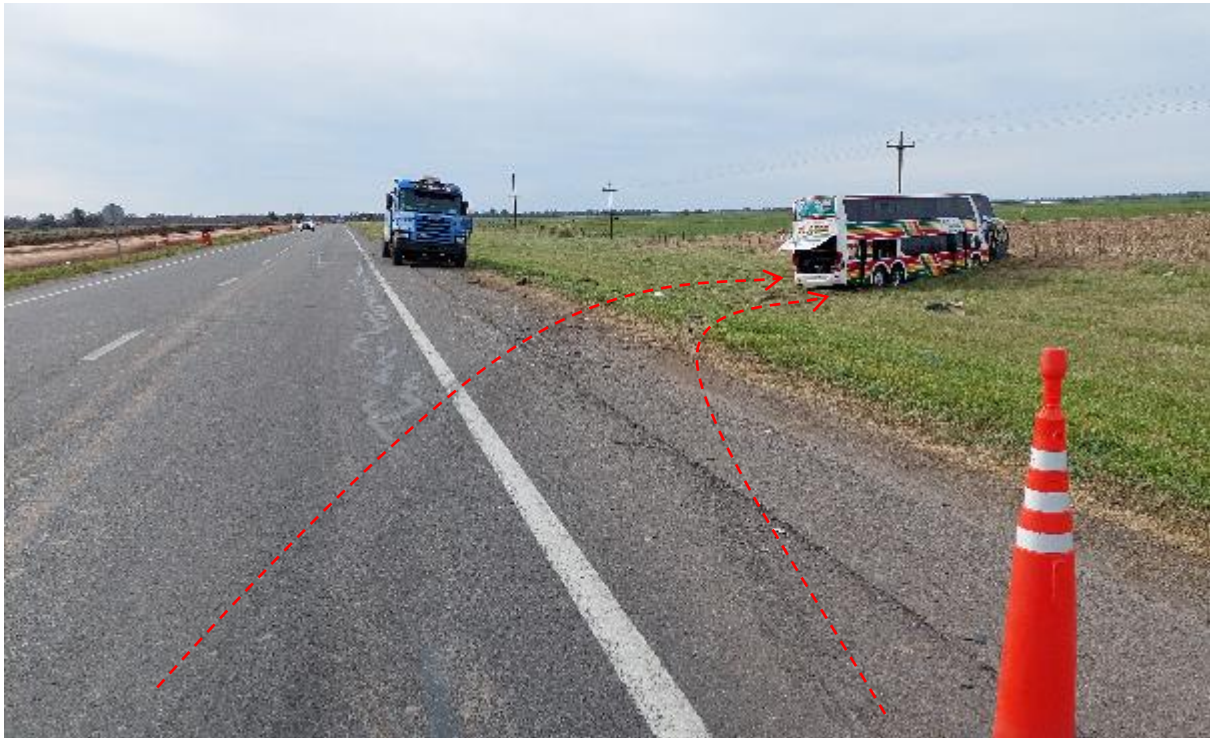
Figura 15. Huellas de frenado pos colisión del Vehículo 2 egresando del carril y banquina e ingresando a la zona de préstamo hacia San Miguel del Monte. Fuente: JST, 2023
