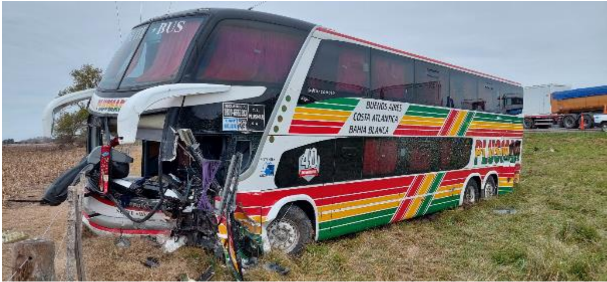
Figura 10. Daños en el vértice anterior izquierdo del Vehículo 2. Fuente: JST, 2023
