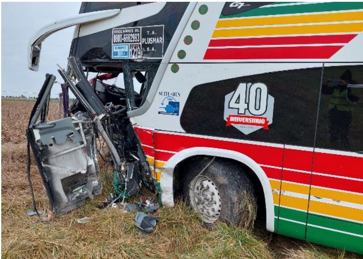
Figura 11. Daños en el lateral izquierdo del Vehículo 2. Fuente: JST, 2023
