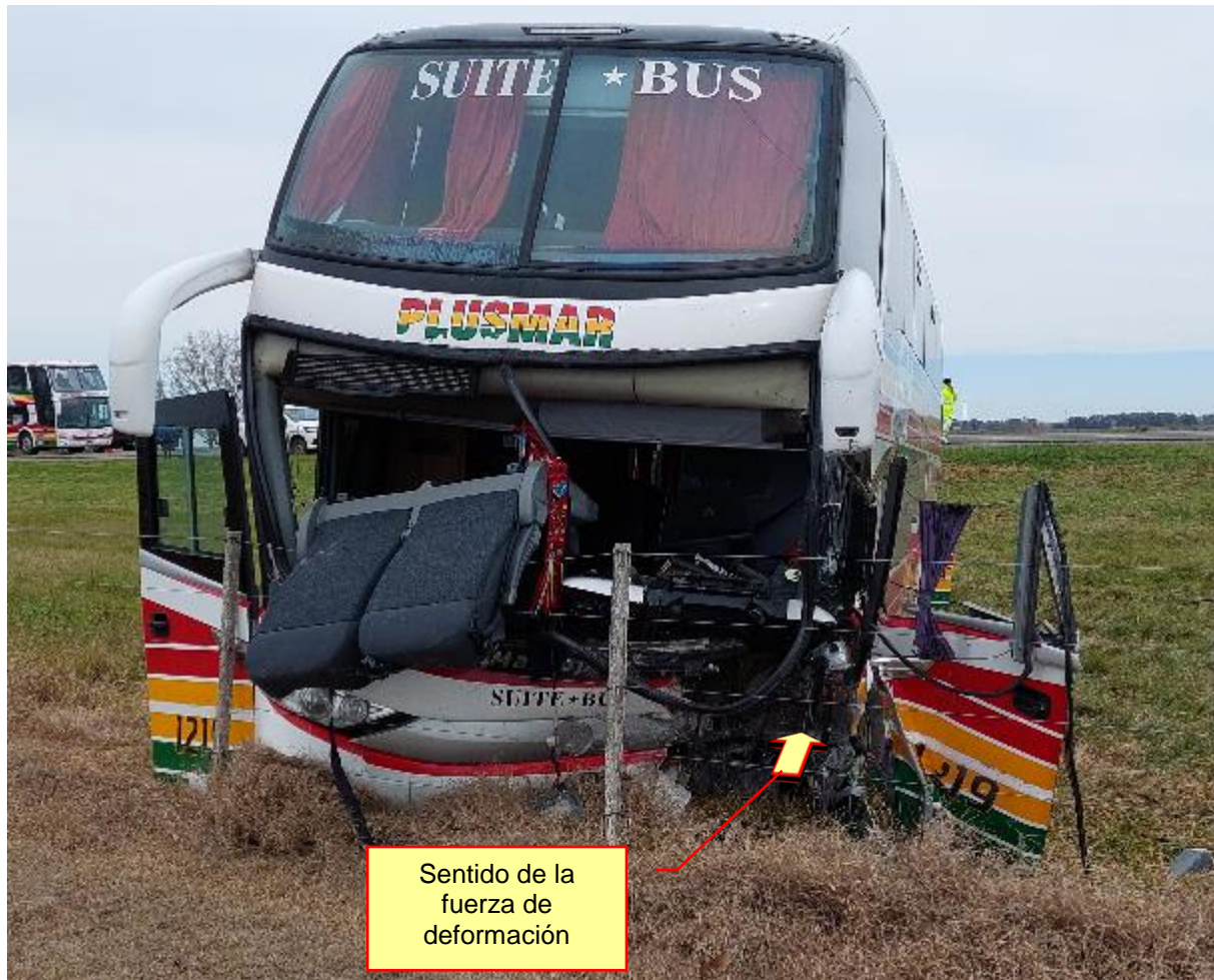
Figura 9. Daños en el sector anterior del Vehículo 2. Fuente: JST, 2023
