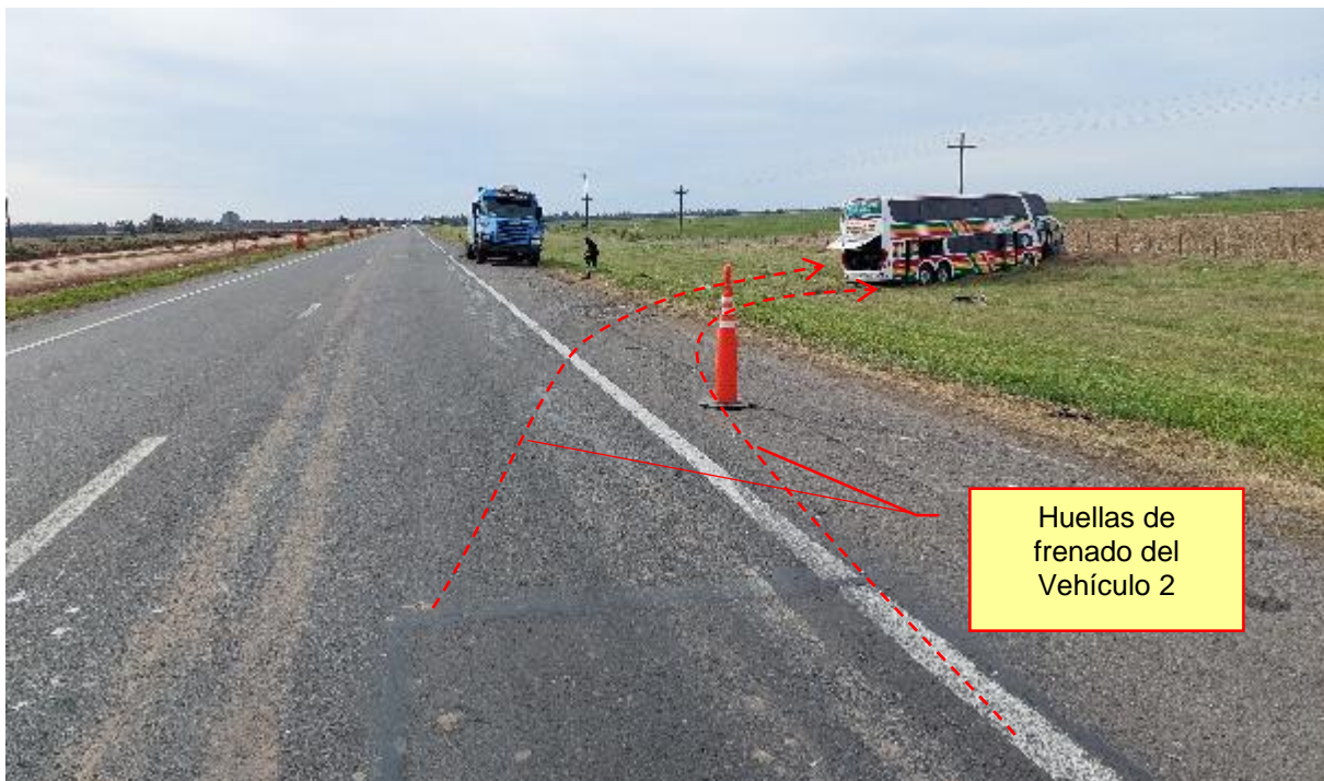
Figura 14. Impresión de las huellas de frenado pos colisión sobre el carril y banquina hacia San Miguel del Monte. Fuente: JST, 2023
