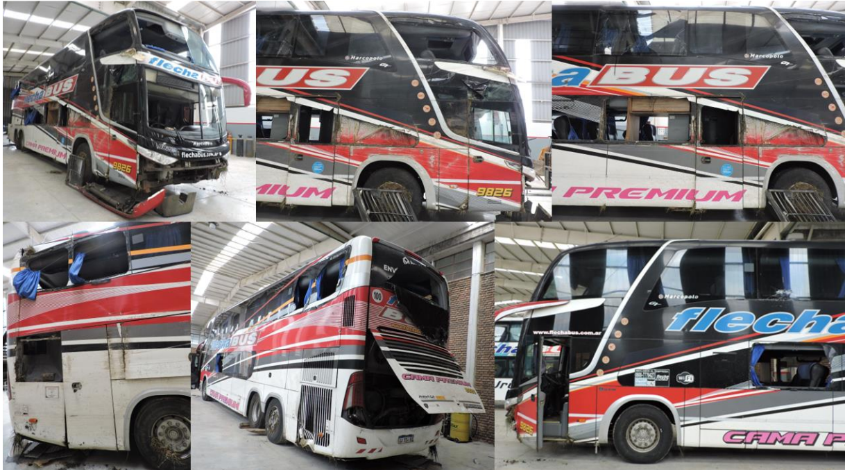
Figura 6. Visualización de los daños sufridos por el ómnibus doble piso. Fuente: JST, 2023
