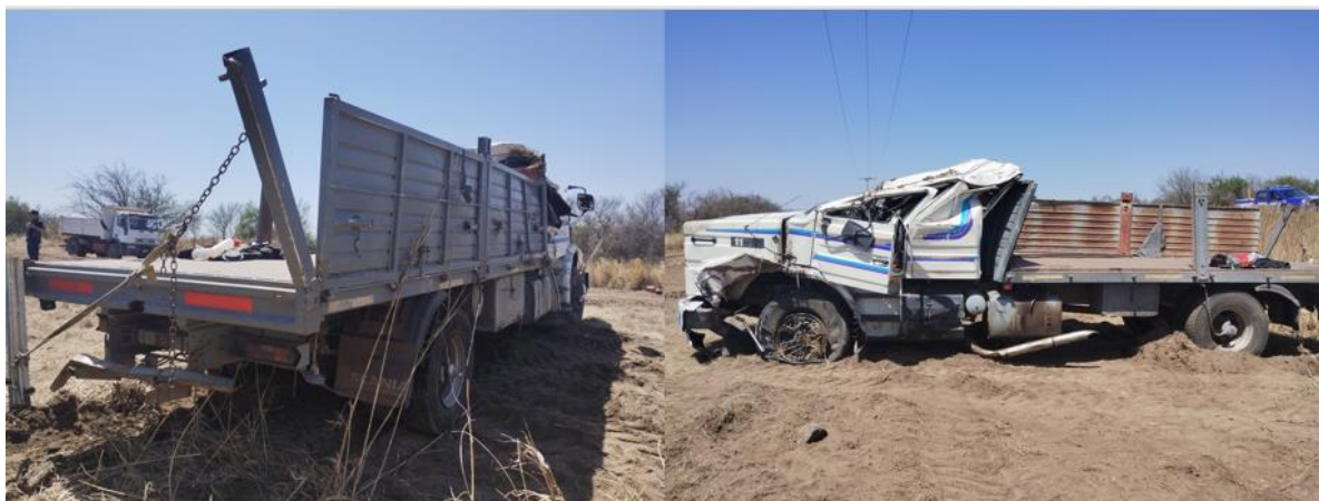
Figura 7. Visualización de los daños constatados sobre la cabina del Vehículo 1 poscolisión. Fuente: JST, 2023
