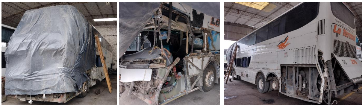
Figura 6. Daños en el Vehículo 1. Fuente: JST, 2023
