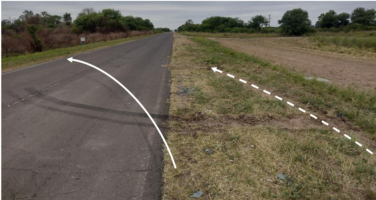
Figura 16. La imagen muestra la marca de derrape posimpacto producida por el Vehículo 1 al reingresar a la ruta (línea blanca continua) con un movimiento de rototraslación antihoraria. Sobre la banquina se indica la continuidad de las marcas de neumático de los ejes traseros de la unidad.
