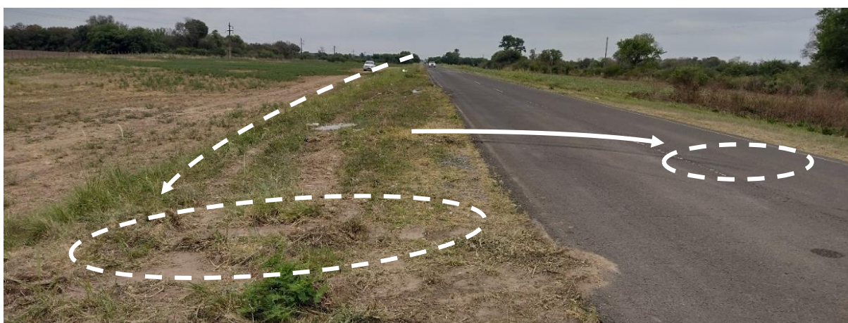
Figura 17. Imagen capturada en el sentido opuesto al del desplazamiento del Vehículo 1, en la cual se señala con círculos blancos de línea discontinua el sector de finalización de las marcas de neumático sobre la banquina y la calzada. Fuente: JST, 2023
