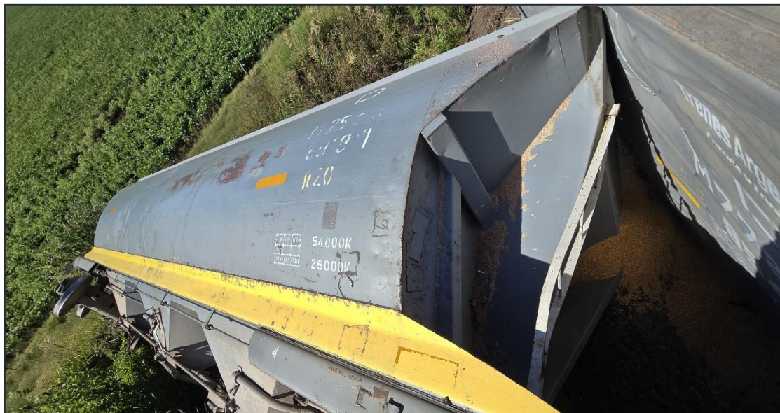
Figura 3. Vagón volcado con pérdida de carga. Fuente: JST, 2024
