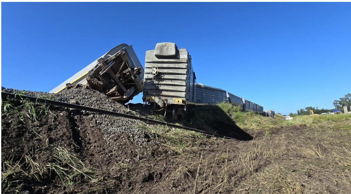
Figura 7. Distribución zigzagueante de los vagones con respecto al eje de la vía. Fuente: JST, 2024
