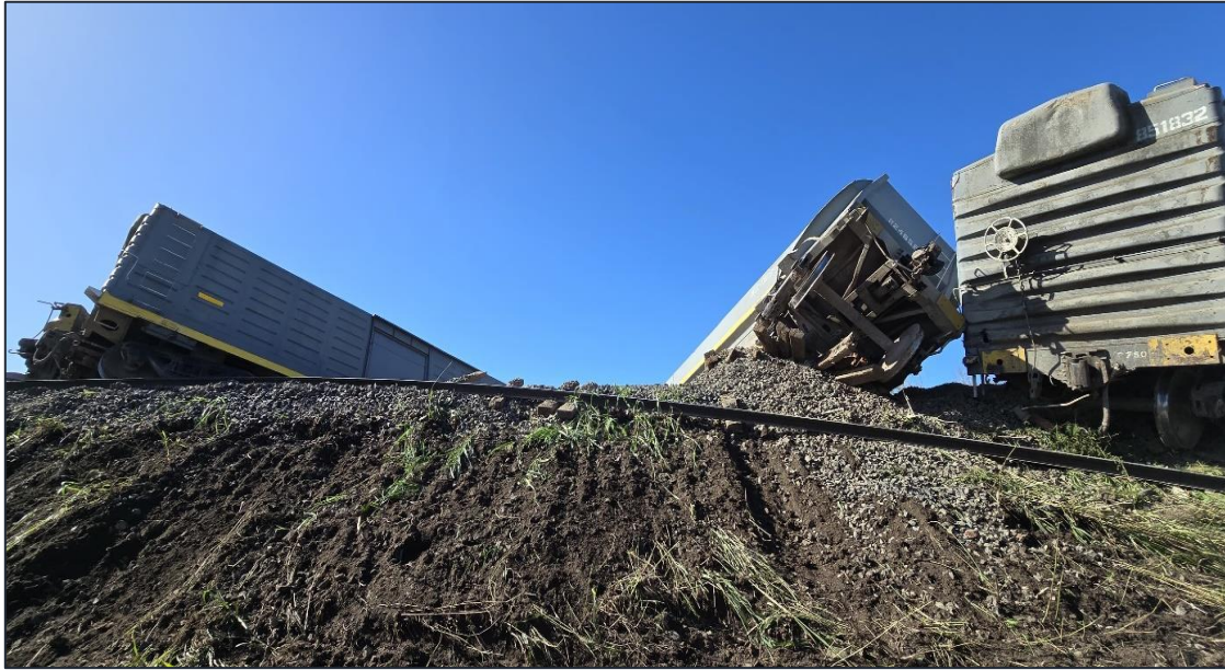
Figura 2. Vagones volcados con arrastre de la superestructura de vía.
