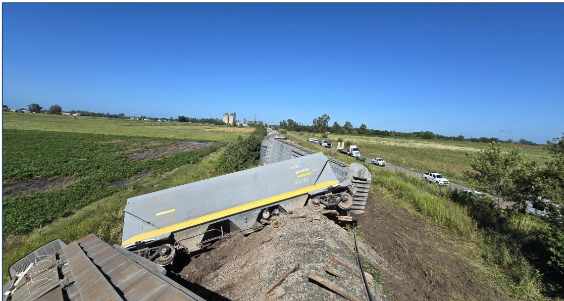
Figura 1. Vagones descarrilados pertenecientes al tren H92 en cercanías de la estación Alcorta.
