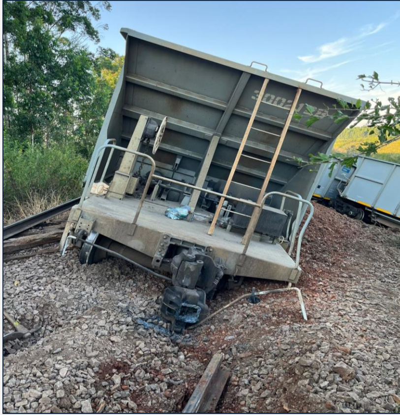
Figura 3. Vagones descarrilados y rotura de rieles y durmientes. Fuente: JST, 2024
