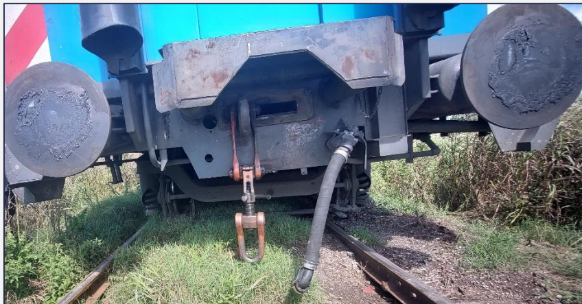
Figura 2. Bogie descarrilado del furgón FU 2567. Fuente: JST, 2024
