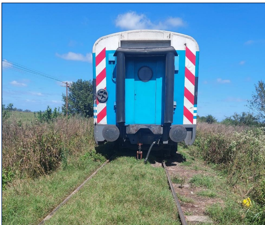
Figura 1. Vista del primer coche del tren FU 2567 con su primer bogie descarrilado hacia el lado izquierdo de la vía en el sentido de la marcha. Fuente: JST, 2024
