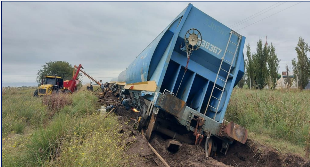
Figura 2. Imagen del descarrilamiento al momento de las tareas de trasbordo de la carga, en sentido a la estación Francisco Madero. Fuente: JST, 2024
