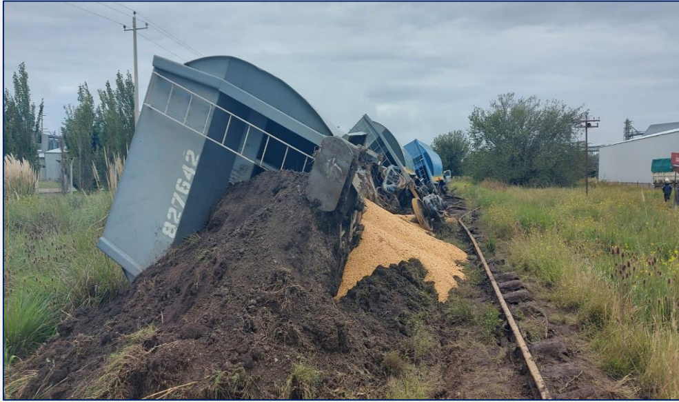
Figura 1. Imagen de los vagones afectados por el descarrilamiento con pérdida de carga, en sentido a la estación Pehuajó. Fuente: JST, 2024
