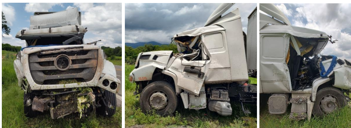
Figura 13. Daños constatados en la unidad tractora del Vehículo 2. Fuente: JST, 2024
