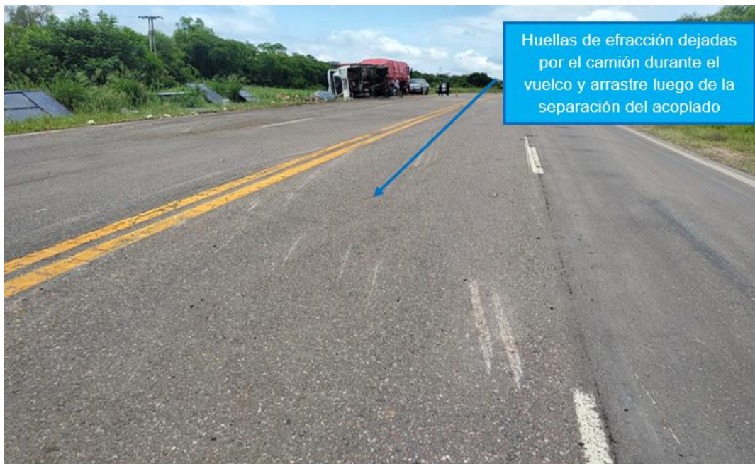
Figura 17. Vista norte-sur donde se observan las huellas de efracción dejadas por el camión del Vehículo 1 durante el vuelco y arrastre hasta su posición final. Fuente: JST, 2024
