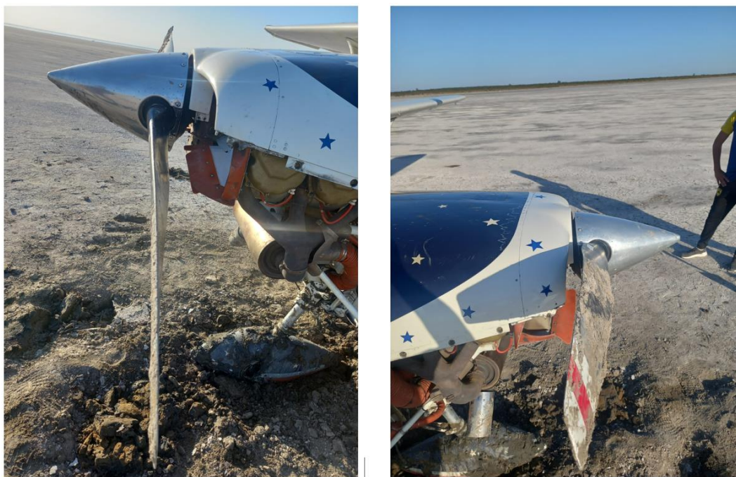
Figura 4. Daños en la hélice y carenado de tren de nariz. Fuente: investigación JST
