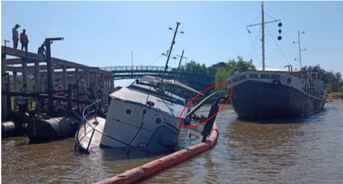
Figura 16. Vista desde popa del buque hundido, se observa la barrera de contención sobre su estribor y una tubería de descarga conectada con el buque Gral. Maglione, con el propósito de achicar la pileta del María del Carmen.
