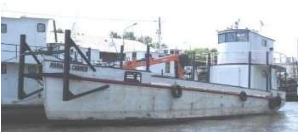
Figura 3. El B/M María del Carmen por su banda de babor. Foto antigua donde se observa que anteriormente tenía una estructura en la proa para el empuje de barcaza.
