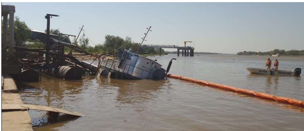
Figura 15. Se observa el buque hundido y escorado a estribor. Vista por la aleta de babor. Se aprecia también la barrera desplegada para la contención de eventuales derrames de hidrocarburos
