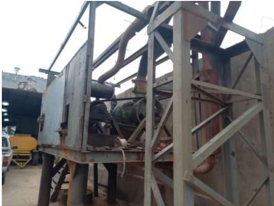
Figura 14. Bomba de rebombeo que se utilizaba desde tierra en la maniobra de descarga
