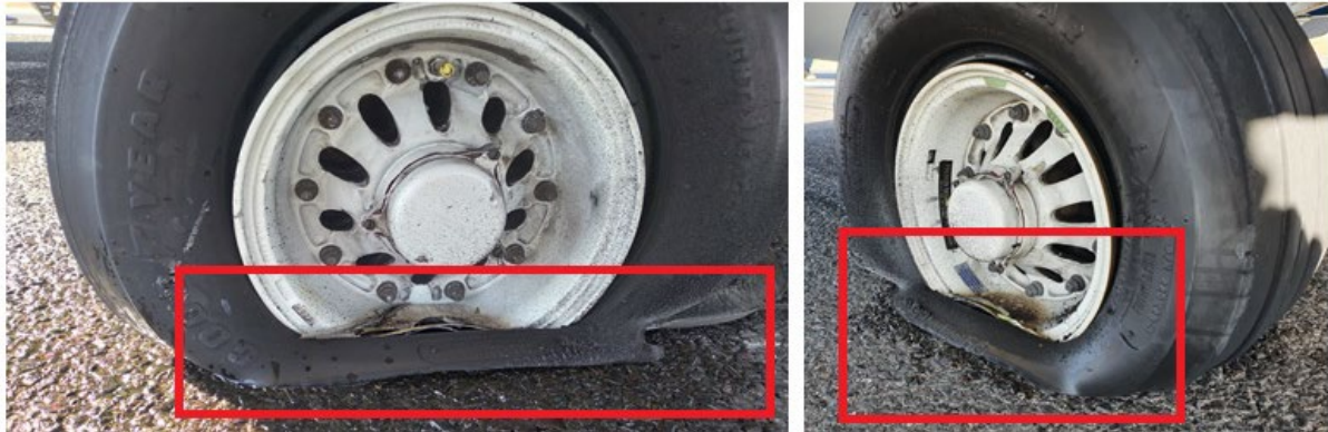
Figura 2. Imagen de los daños en las cubiertas y mazas. Fuente: investigación JST
