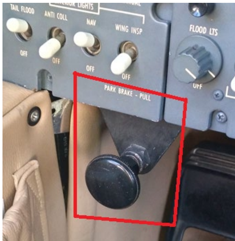
Figura 3. Palanca de accionamiento del freno de estacionamiento. Fuente: investigación JST
