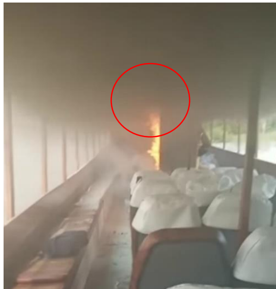
Figura 10. Foto del interior de la lancha vista desde popa hacia proa. Notar las llamas en el recubrimiento de madera del sistema de exhaustación o conducto de escape.
