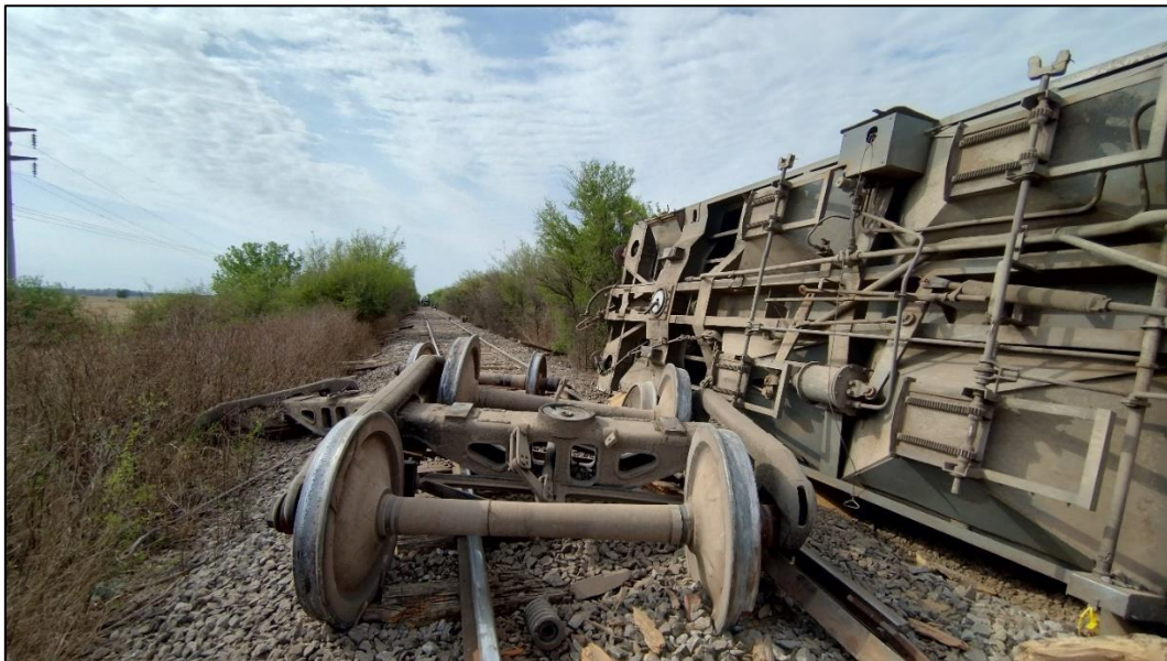
Figura 6. Tolvas volcadas con desprendimiento de bogies y pares montados. Fuente: JST, 2024
