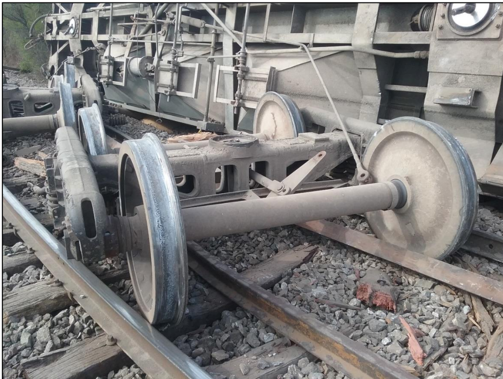
Figura 4. Vagón volcado con desprendimiento de bogies y pares montados. Fuente: JST, 2024
