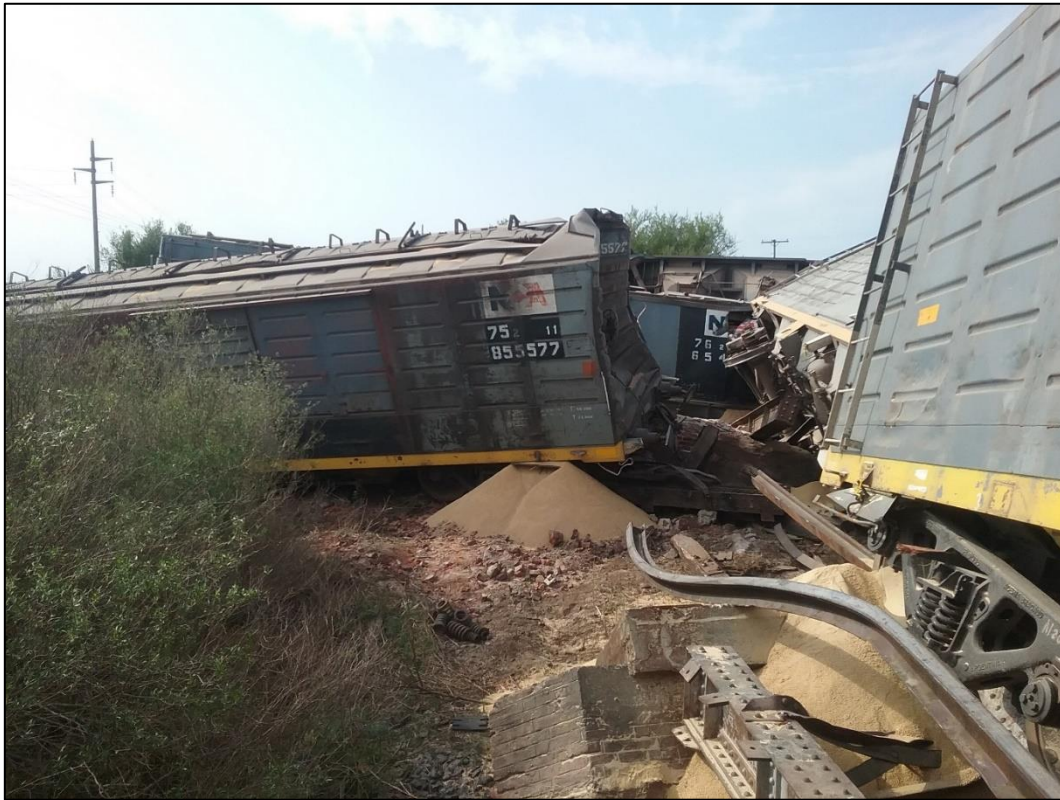
Figura 5. Vagones descarrilados y volcados con pérdida de carga y daños visibles en las inmediaciones de la alcantarilla Fuente: JST, 2024
