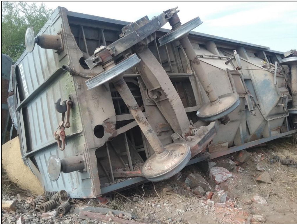
Figura 3. Vagón n.º 648113 volcado con pérdida de carga transportada. Fuente: JST, 2024
