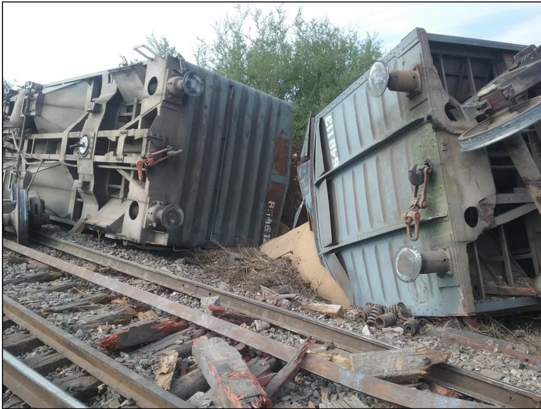
Figura 2. Tolvas volcadas sobre los márgenes laterales de la vía, con pérdida de carga.
