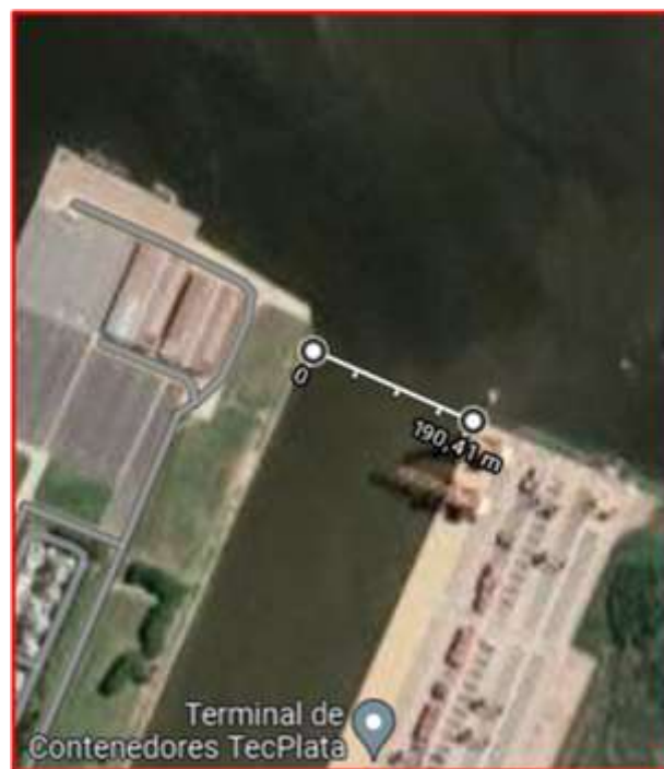
Figura 6. Ancho del acceso al gran dock central. Medido en 190 m Fuente: Google Maps
