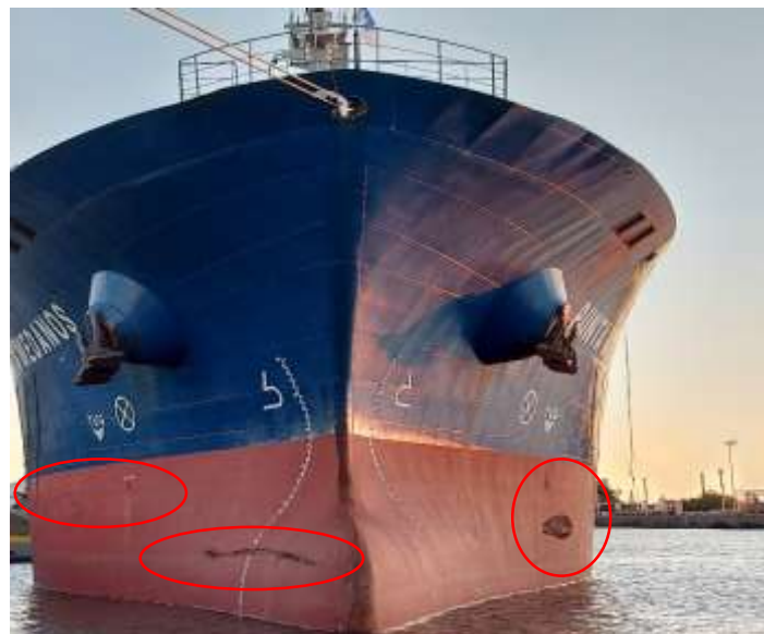
Figura 12. Daños del B/T Punta Médanos
