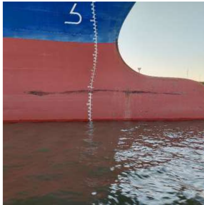
Figura 13. Daños sobre la banda de estribor en el B/T Punta Médanos
