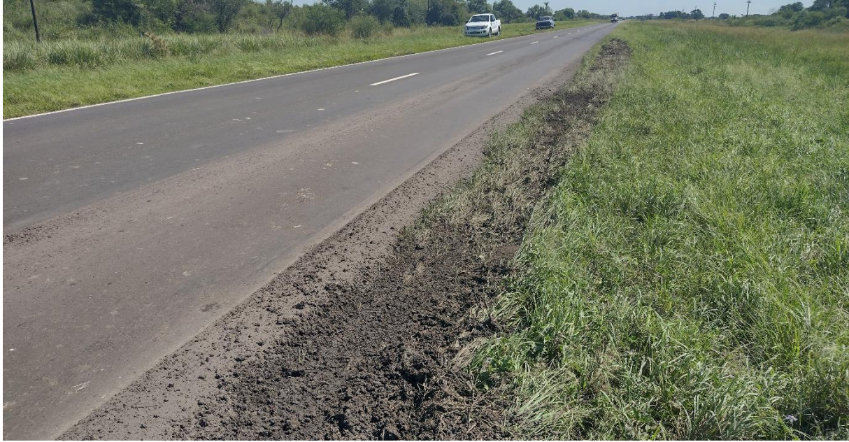
Figura 11. Marcas de neumático producidas por las ruedas derechas del Vehículo 1 sobre la banquina durante su trayectoria inestable. Fuente: JST, 2024
