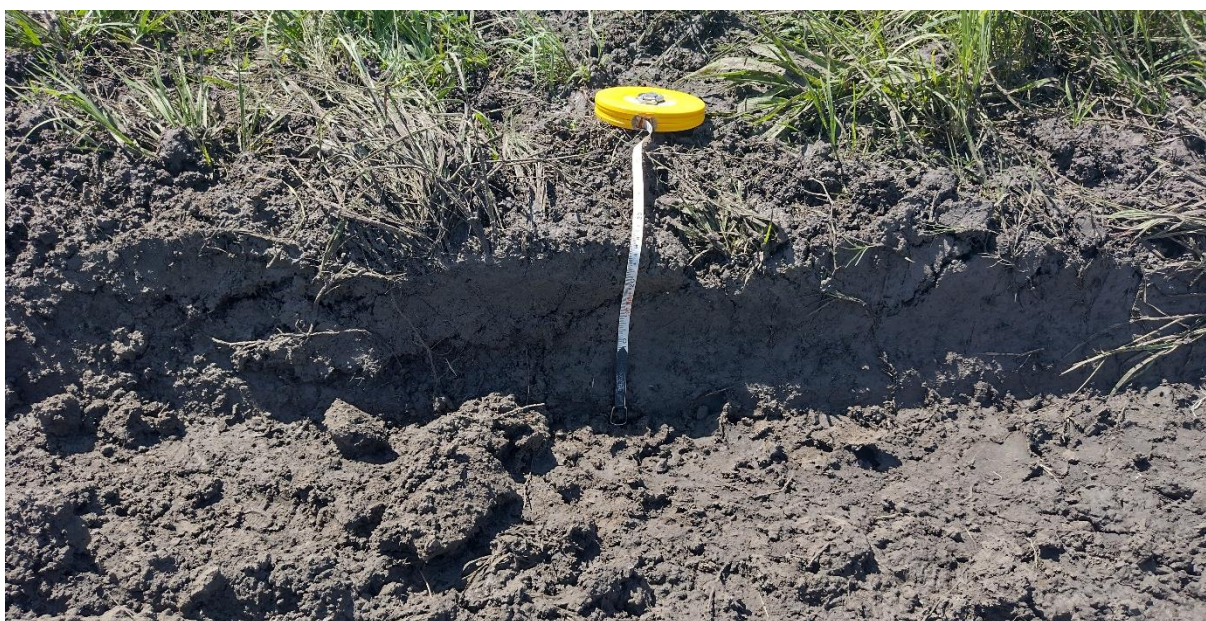
Figura 10. La imagen muestra la profundidad del hundimiento de la huella producida por el Vehículo 1 en el barro de la banquina, la cual alcanzó los 25 cm de profundidad. Fuente: JST, 2024
