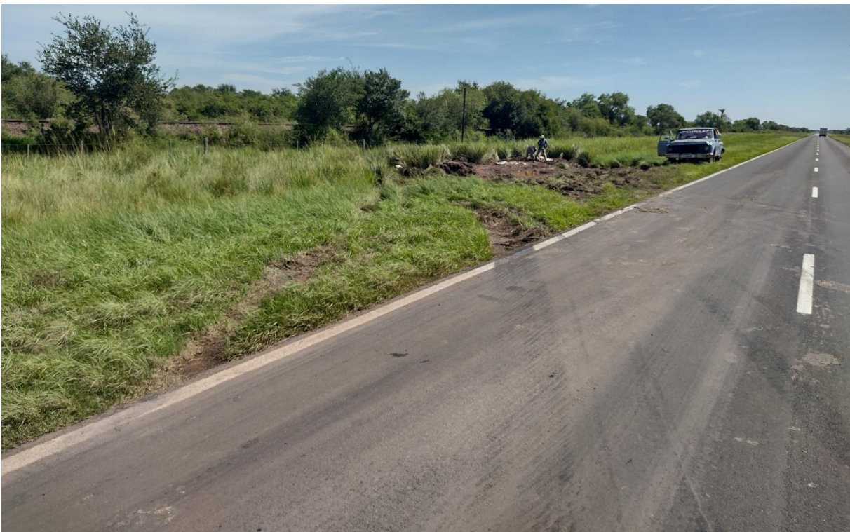
Figura 14. Marcas de derrape producidas por el Vehículo 1 al despistar por el lado opuesto al de su circulación. Fuente: JST, 2024
