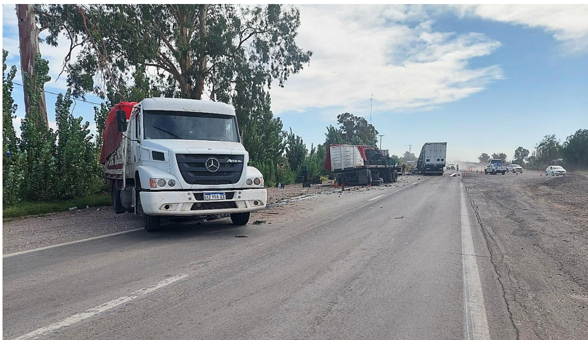
Figura 1. Posición final del Vehículo 1: camión separado del acoplado, ambos sobre el margen noroeste de la ruta. Fuente: JST, 2024
