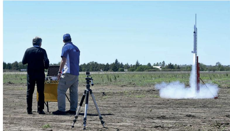
se presentan durante la fase de ascenso. Debido a la disminución de la presión con la altura, también se verifica el despliegue de la operación de la carga útil y que todos sus componentes funcionen con normalidad.
