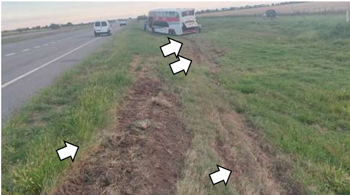
Figura 10. Marcas de arrastre y marcas duales sobre la banquina. Fuente: JST, 2024
