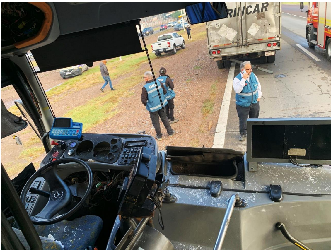
Figura 10. Fotografía del interior del Vehículo 2. Se observa el habitáculo del conductor con daños en el torpedero y restos vítreos esparcidos. Fuente: Mailen , 2024
