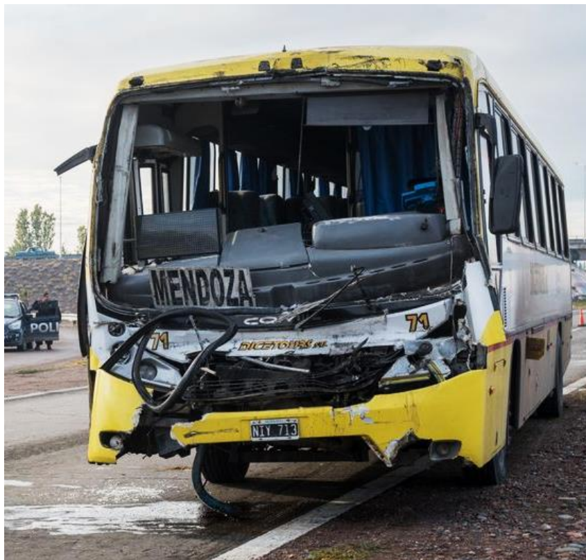
Figura 8. Fotografía del Vehículo 2. Se observan daños localizados principalmente en el sector anterior. Fuente: Sitio Anido , 2024
