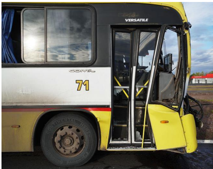
Figura 9. Fotografía parcial del lateral derecho del Vehículo 2. Se observa la orientación de los daños; de adelante hacia atrás. Fuente: Sitio Anido , 2024
