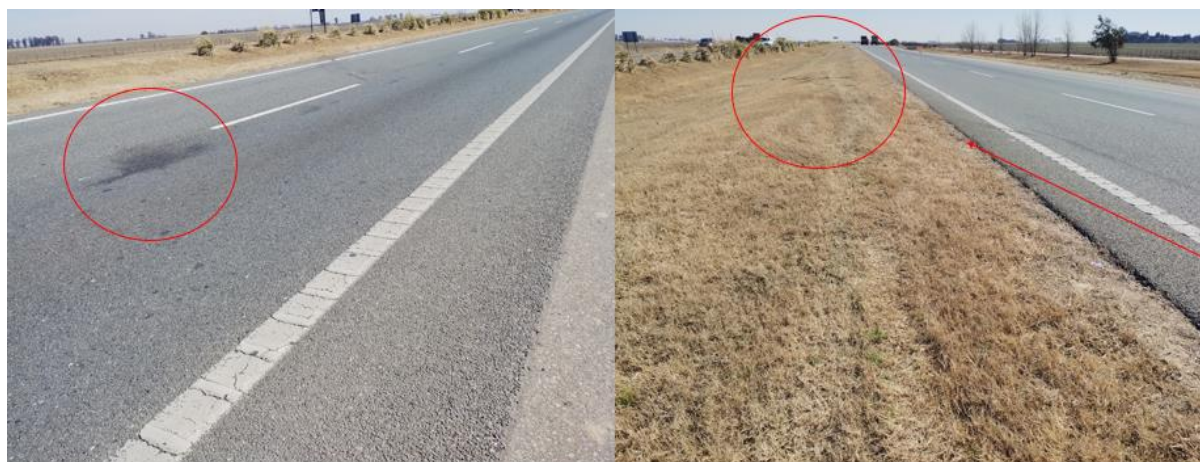
Figura 9. En la imagen de la izquierda, se observa la zona de colisión demarcada por manchas de fluidos dinámicos, mientras que, en la imagen de la derecha, pueden observarse rastros de manchas de fluidos dinámicos que indican la trayectoria del Vehículo 2 y el lugar de su posición final. Fuente:
