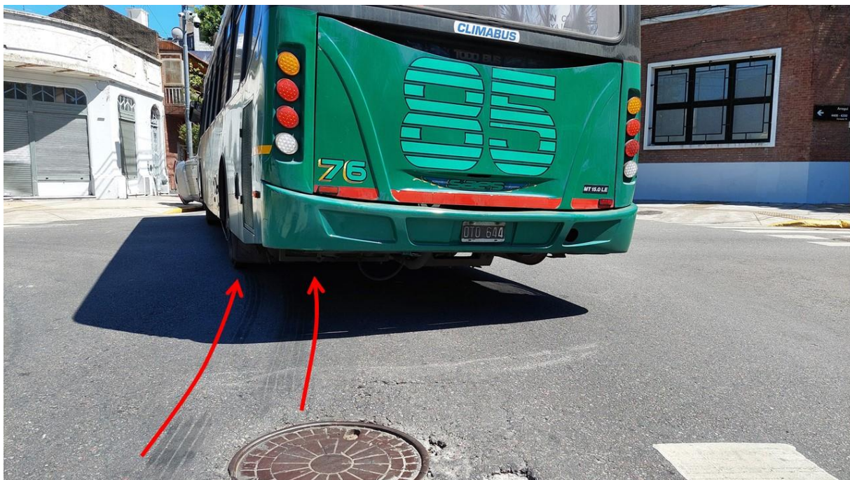
Figura 11. Continuación de las huellas de frenada preimpacto del Vehículo 1. Fuente: JST, 2023
