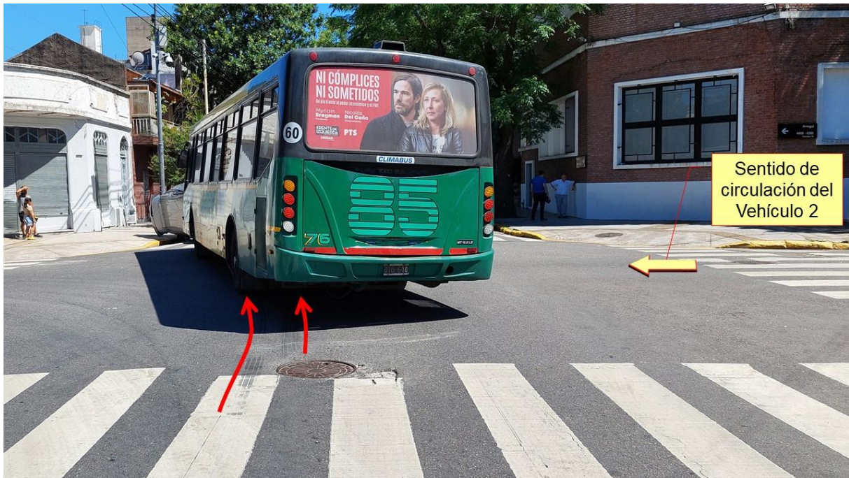
Figura 10. Inicio huella preimpacto neumático trasero izquierdo del Vehículo 1. Fuente: JST, 2023
