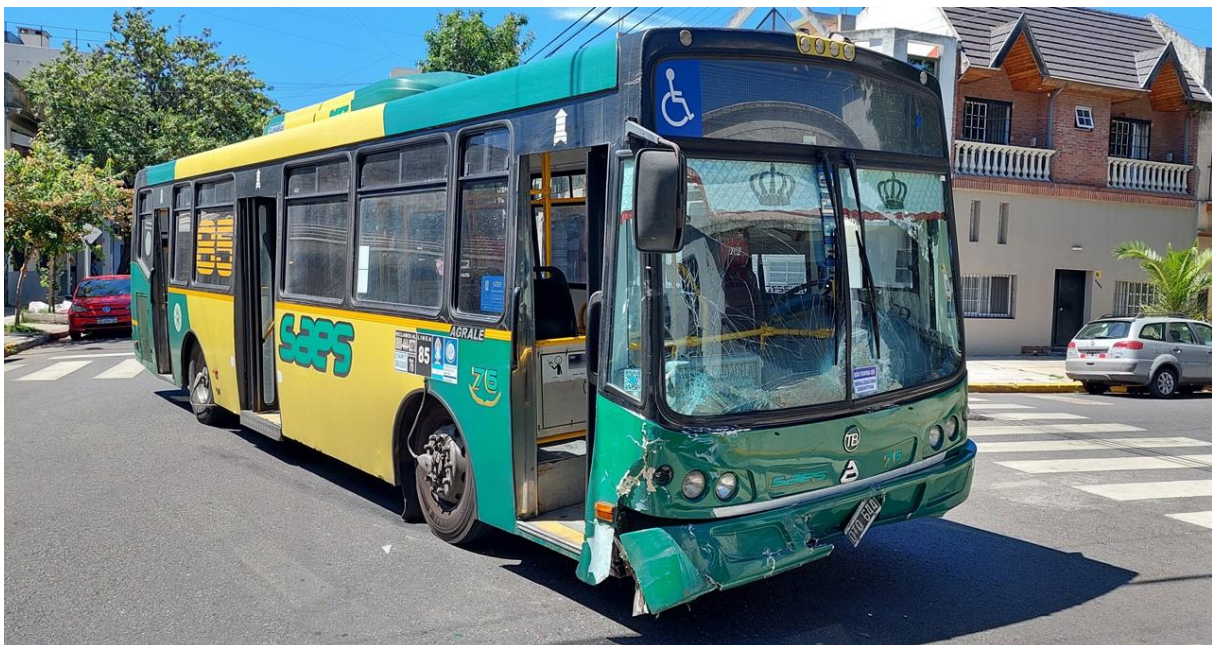
Figura 8. Daños producto de la colisión con el Vehículo 2. Fuente: JST, 2023
