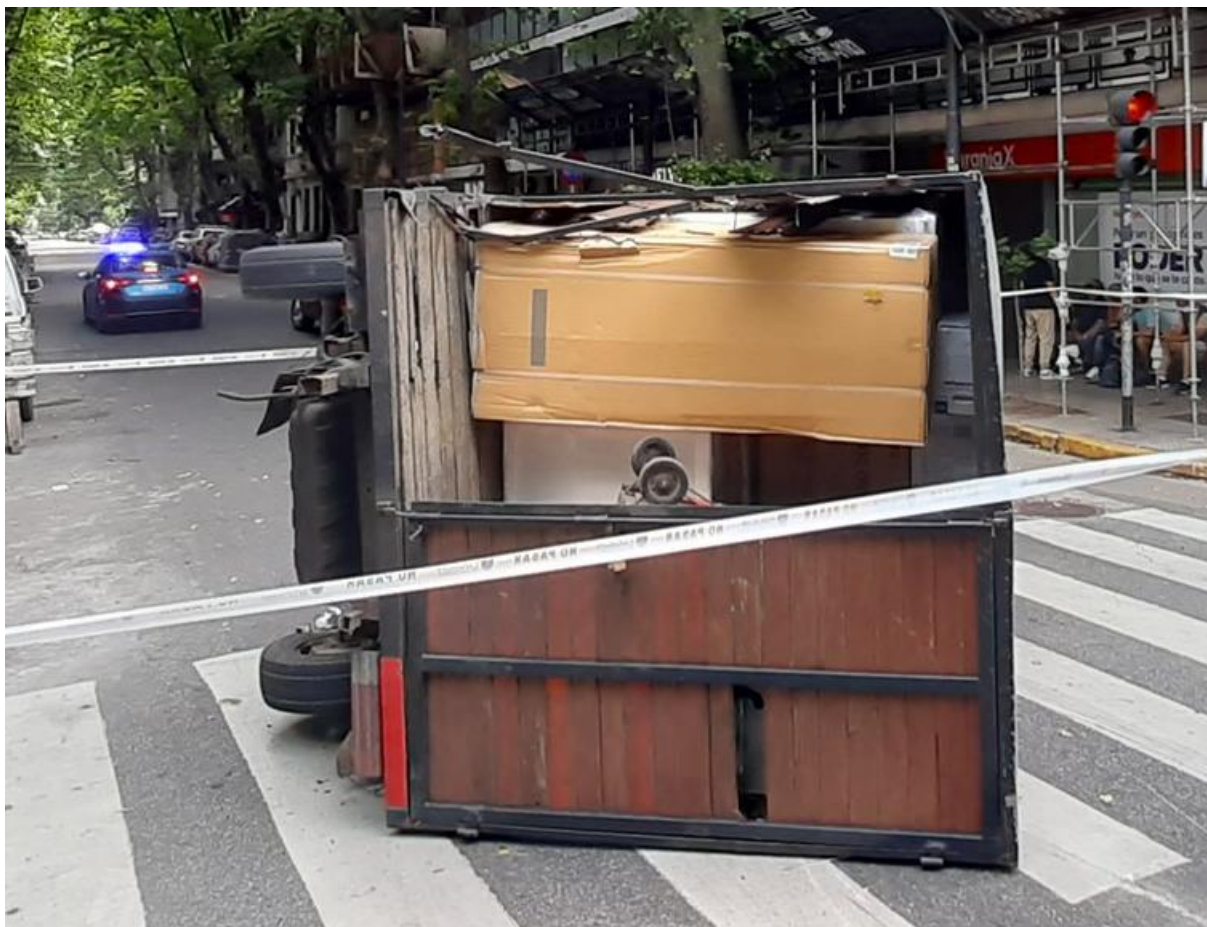
Figura 9. Pliegue de parantes y desprendimiento parcial de paneles del lateral izquierdo de la caja de carga. Fuente: JST, 2023
