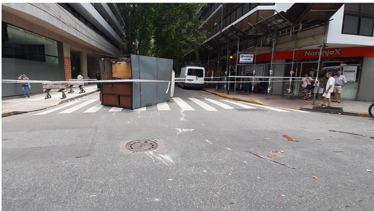
Figura 12. Efracciones generadas por el lateral derecho del Vehículo 2 durante su traslación posterior al vuelco. Fuente: JST, 2023
