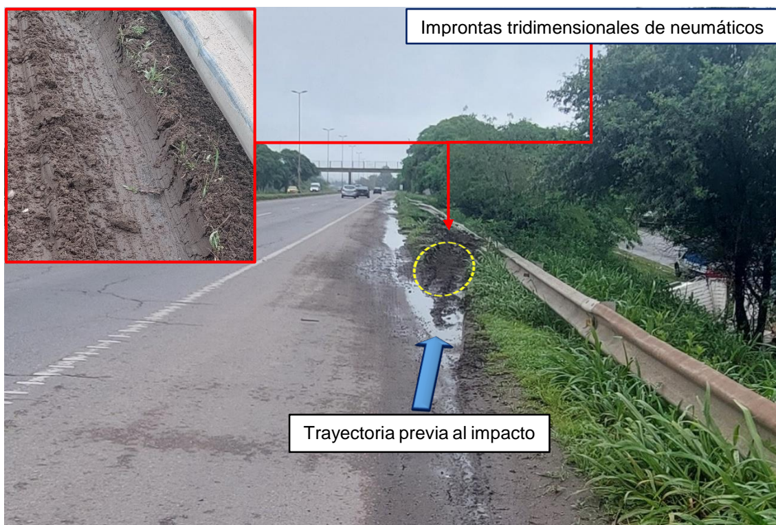
Figura 6. Demarcación de la trayectoria del vehículo previa al impacto y las improntas (3D) dejadas sobre la banquina de tierra. Fuente: JST, 2023
