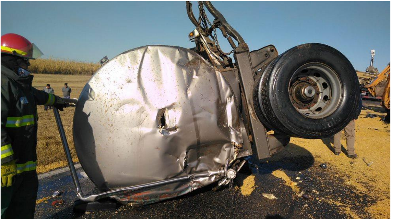
Figura 6. Fotografía que muestra los daños del acoplado del Vehículo 1 tomada desde el sector posterior. Fuente: JST, 2020.
