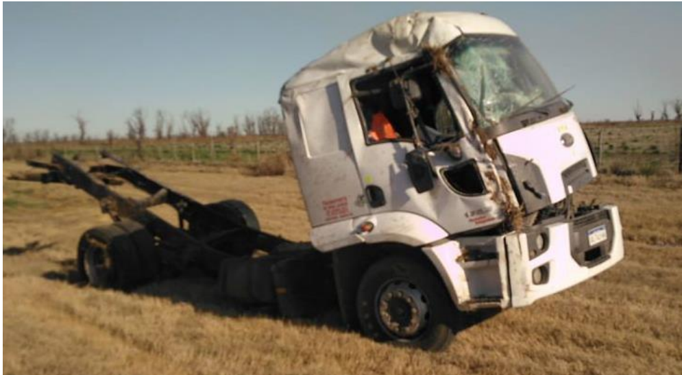
Figura 5. Fotografía que muestra los daños en la unidad tractora del Vehículo 1 tomada desde el sector frontal angular derecho. Fuente: JST, 2020.
