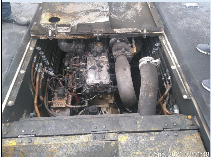
Figura 5. Fotografía del vano del motor, sector incendiado.
