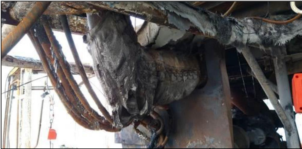
Figura 21. Zona primigenia de origen del fuego. Fuente: Informe Técnico BV, 2021
