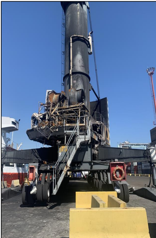
Figura 27. Vista de frente de los restos de la grúa incendiada
