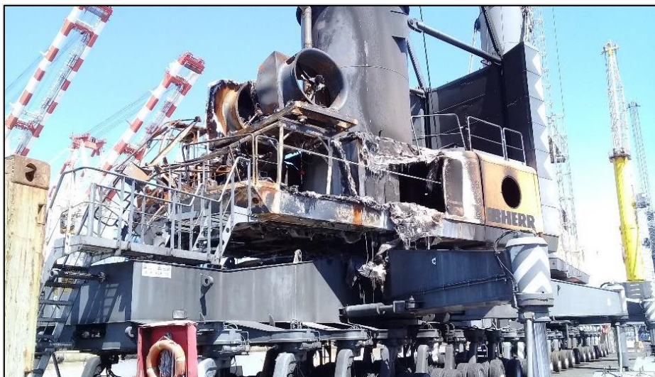
Figura 30. Daños sobre la plataforma giratoria
