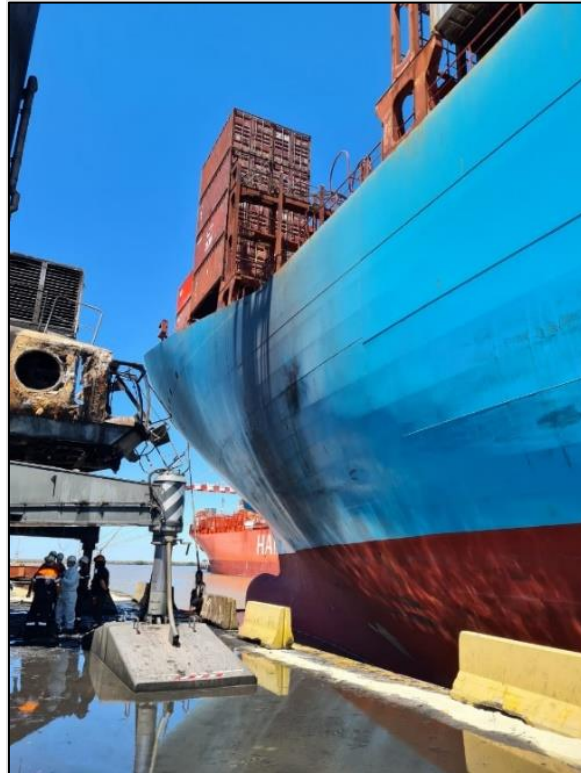
Figura 9. Vista de los daños de pintura en el B/M. Fuente: Informe de PNA, 2021
