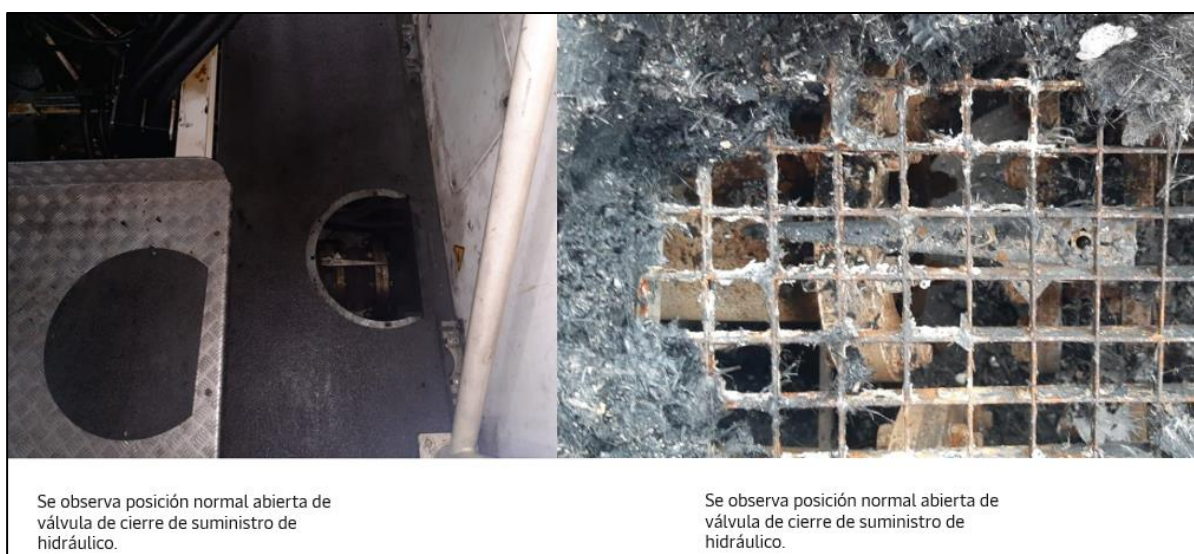
Figura 40. Estado y posición final de la válvula de fluido hidráulico. Fuente: APM Terminals, 2022
