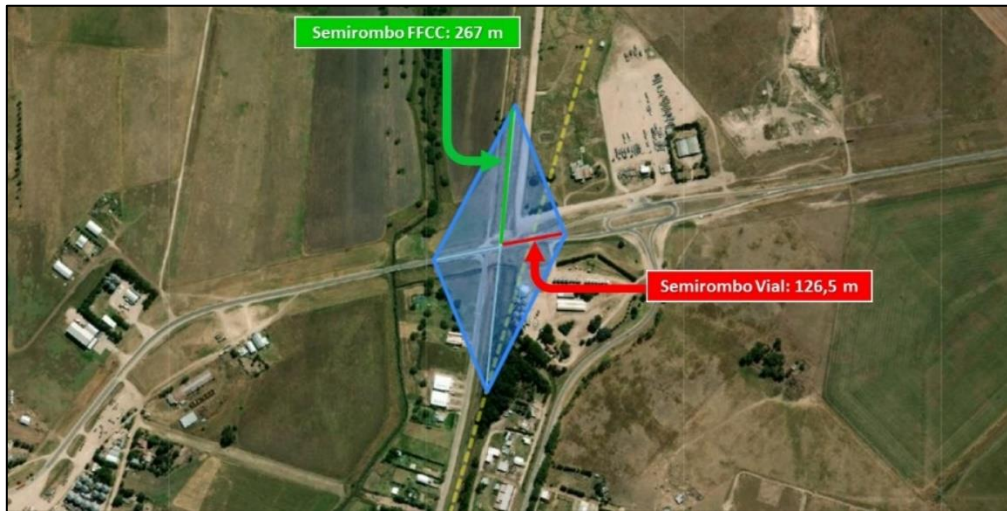
Figura 21. Imagen satelital del rombo de visibilidad del PAN. Fuente: Argenmap. Anotaciones: JST
