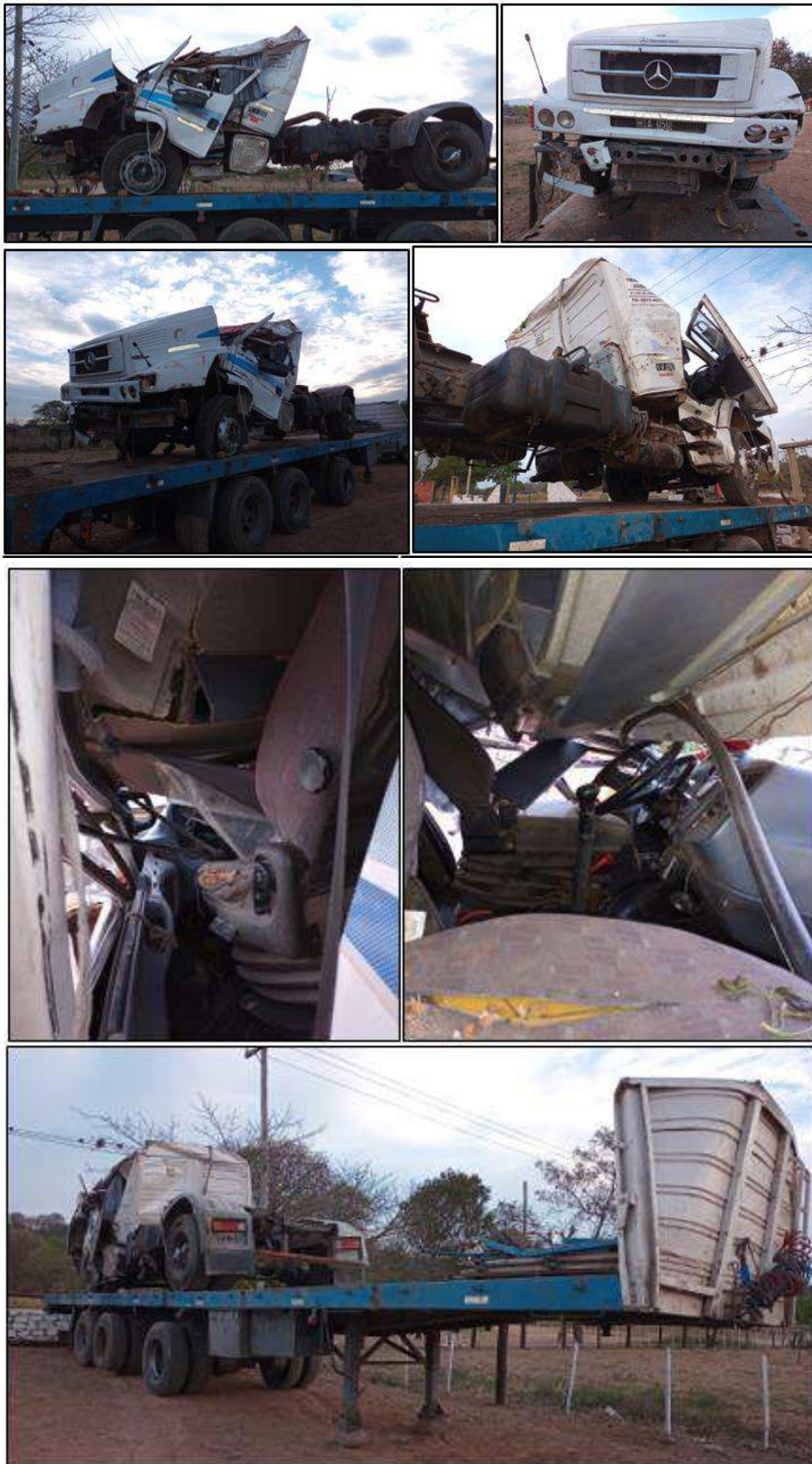
Figura 14. Fotografías de los daños del vehículo 1: a) lateral izquierdo de unidad tractora; b) y c) sector frontal y lateral izquierdo de cabina; d) lateral derecho de cabina; e) y f) interior de la cabina; g) semirremolque. Fuente: JST, 2021.
