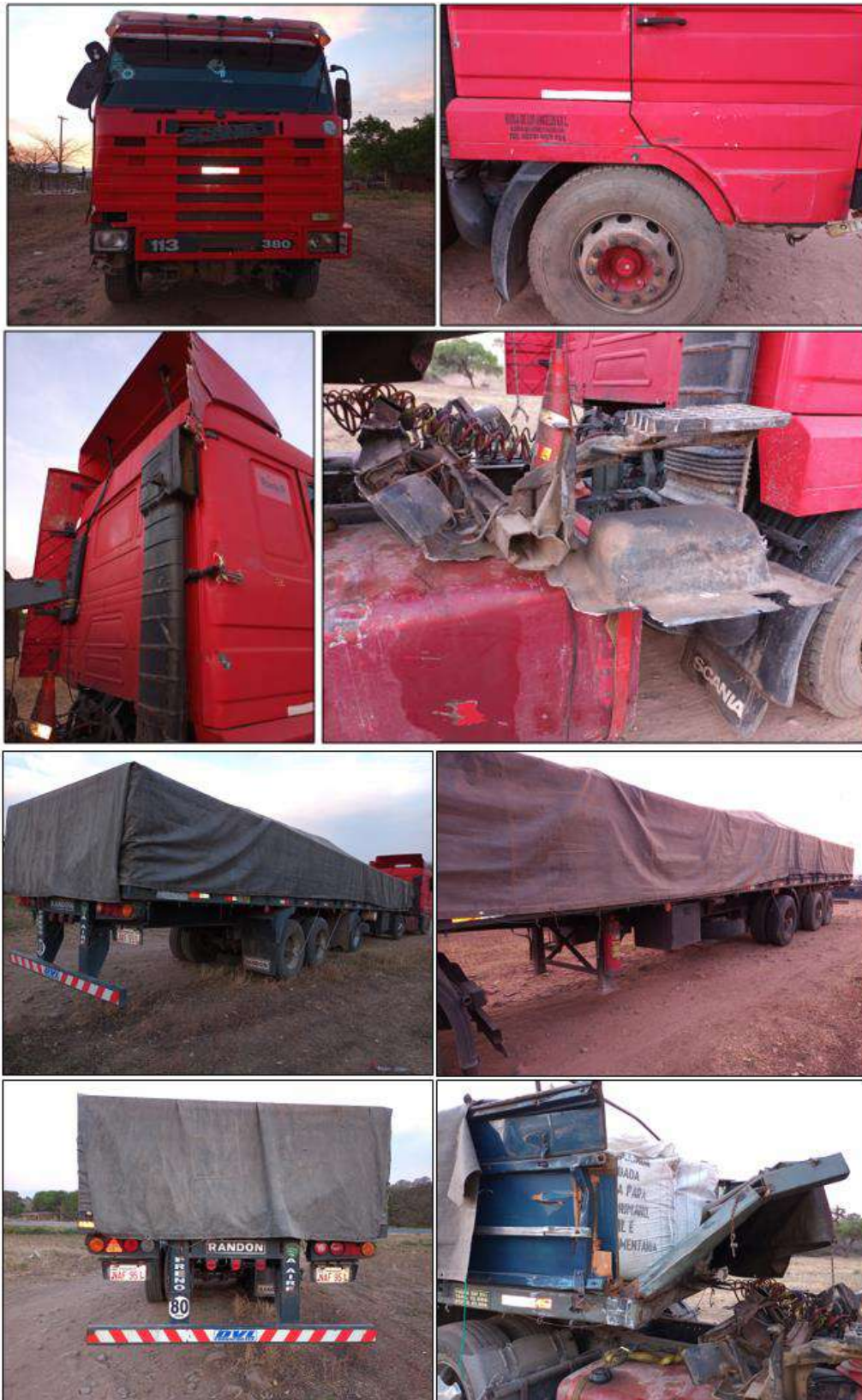
Figura 15. Fotografías de los daños del vehículo 2. a) sector frontal de la cabina; b) sector inferior derecho de la cabina; c) deflector derecho; d) guardabarros desprendido; e), f) y g) estado de los laterales derecho e izquierdo y sector posterior del semirremolque; h) sector anterior derecho. Fuente: JST, 2021.
