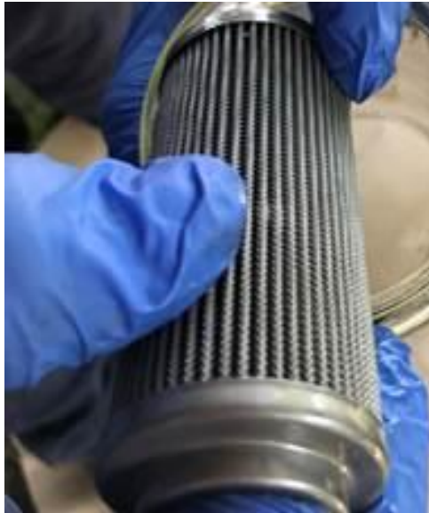
Figura 18. Filtro de combustible derecho
