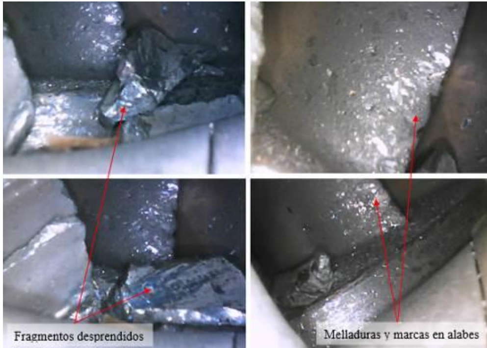
Figura 22. Imágenes de boroscopia en motor izquierdo
