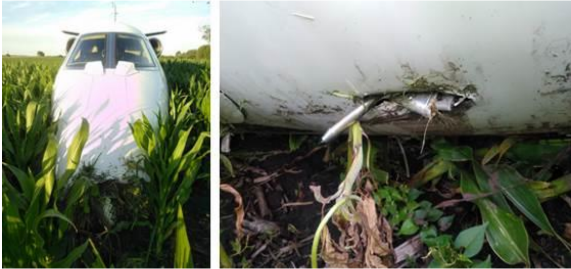
Figura 2. Imagen de daños en el radome y tubo pitot
