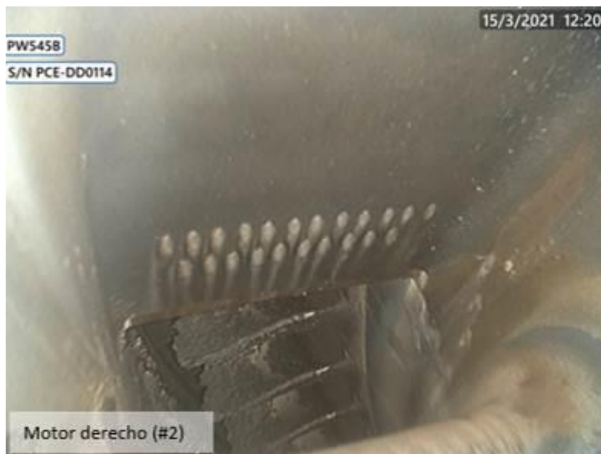
Figura 26. Estado de los alabes de la turbina de alta presión del motor derecho
