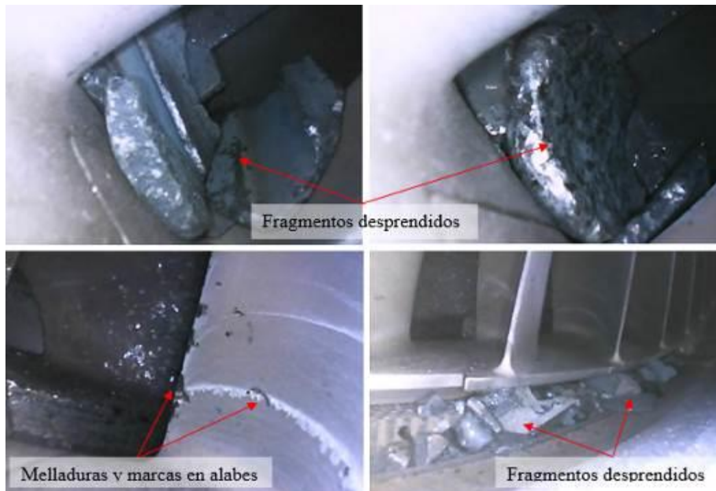
Figura 23. Imágenes de boroscopia en motor derecho
