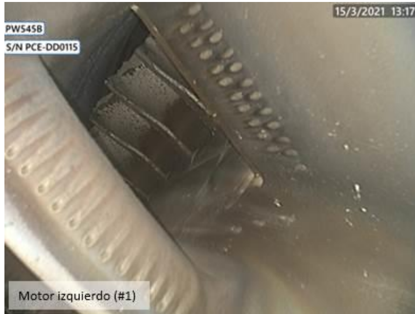
Figura25. Estado de los alabes de la turbina de alta presión del motor izquierdo
