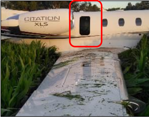
Figura 16. Puerta de salida de emergencia
