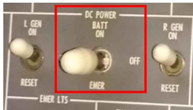
Figura 33. Interruptores de corriente continua
