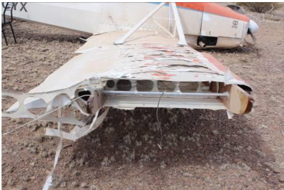
Figura 2. Daños en la puntera de ala derecha
