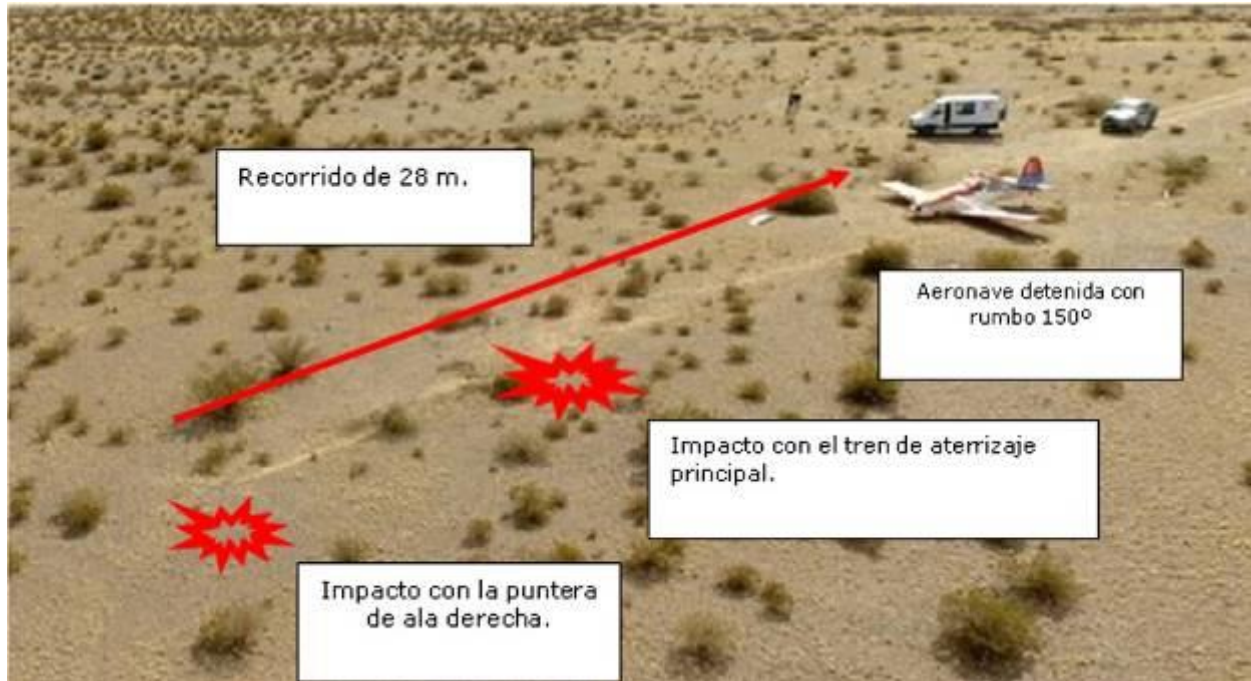
Figura 3. Marcas en el terreno
