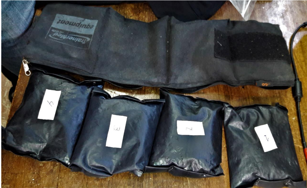
Figura 4. Bolsas de lastre instaladas en la cola del planeador
