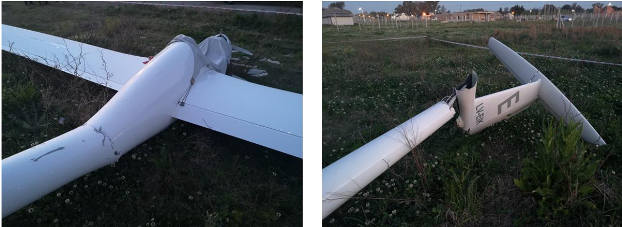
Figura 6. Daños experimentados por la aeronave
