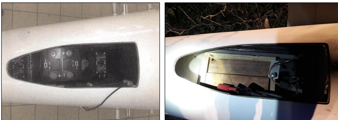
Figura 13. Baterías de litio (izquierda) reemplazadas por una caja de madera con seis pesas (derecha)
