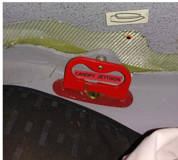
Figura 8. Manivela para apertura y cierre (izquierda) y palanca de expulsión de emergencia de la carlinga (derecha)
