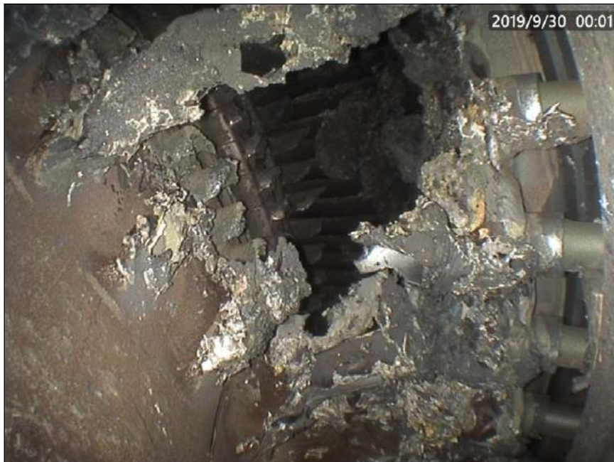
Figura 3. Daños en las etapas de LPT (imagen provista por Austral Líneas Aéreas)
