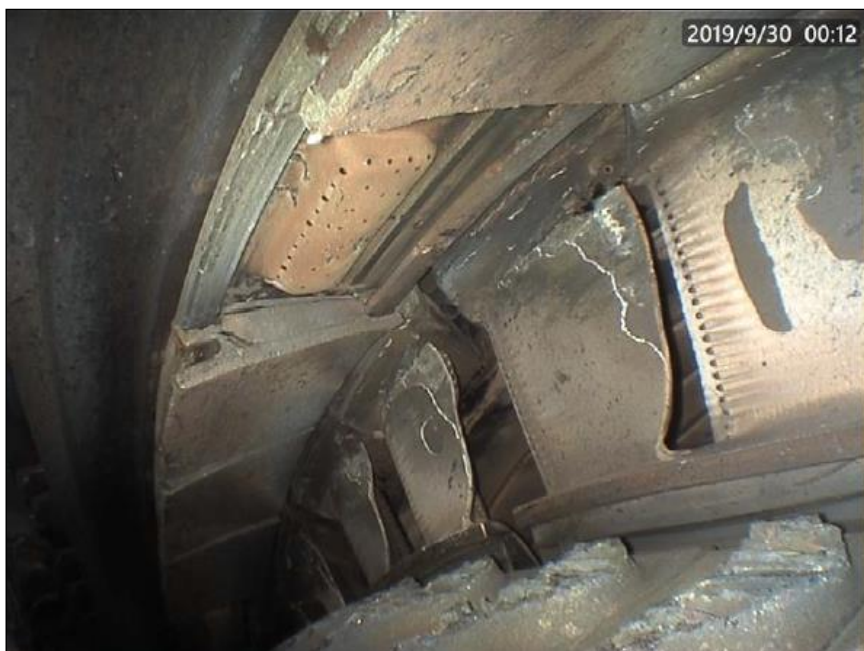
Figura 4. Daños en la carcasa y álabes de HPT (imagen provista por Austral Líneas Aéreas)
