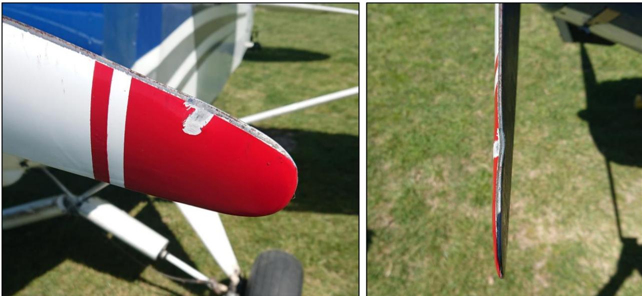
Figura 2. Daños en una de las palas de la hélice
