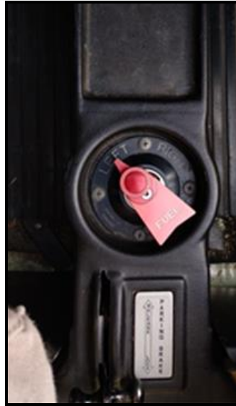
Figura 4. Válvula selectora de tanques de combustible
