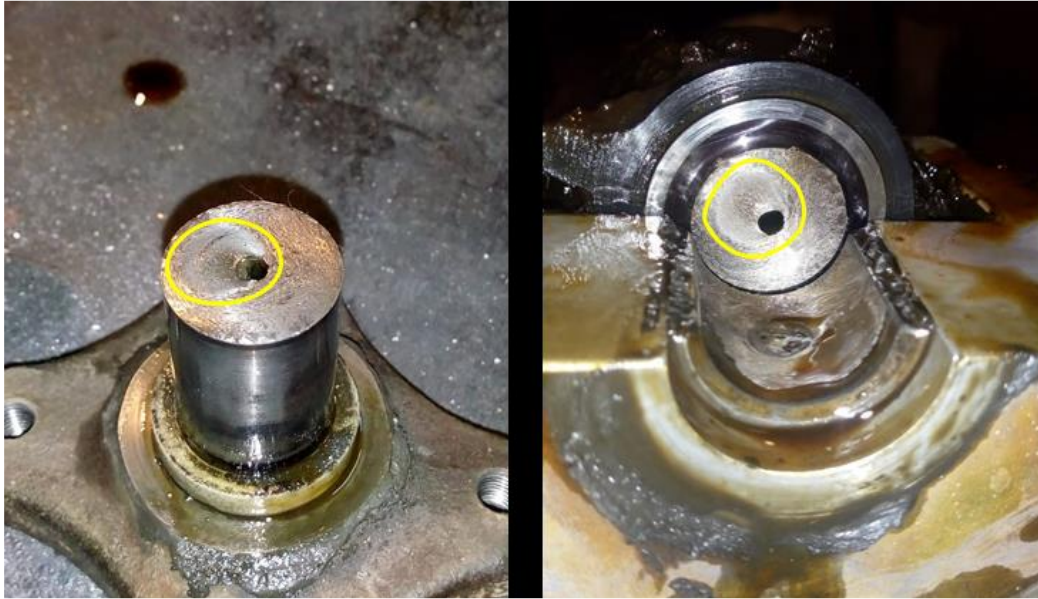
Figura 3. Propagación de la fisura en el eje del actuador
