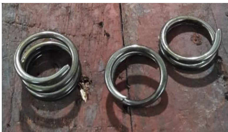
Figura 2. Resorte de la válvula de escape del cilindro 3
