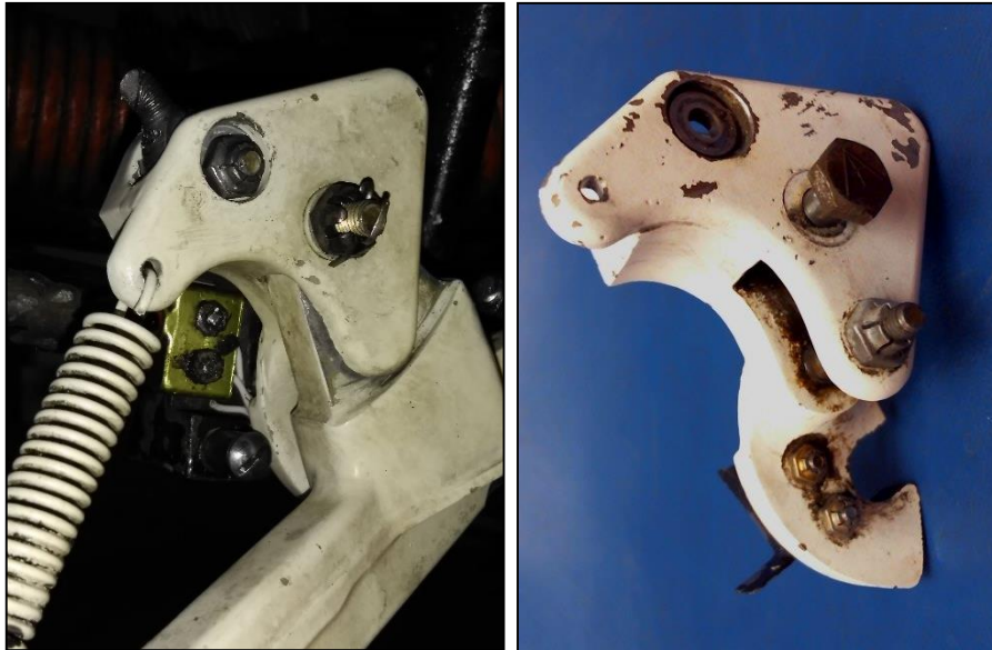
Figura 7. Imagen comparativa de la traba de tren de aterrizaje de nariz (a la izquierda la instalada en el LV-LMG y a la derecha la imagen ilustrativa provista por el TAR)
