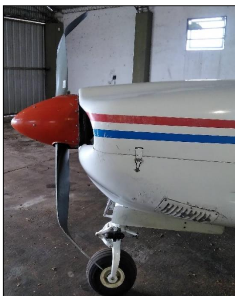
Figura 4. Hélice posterior al accidente
