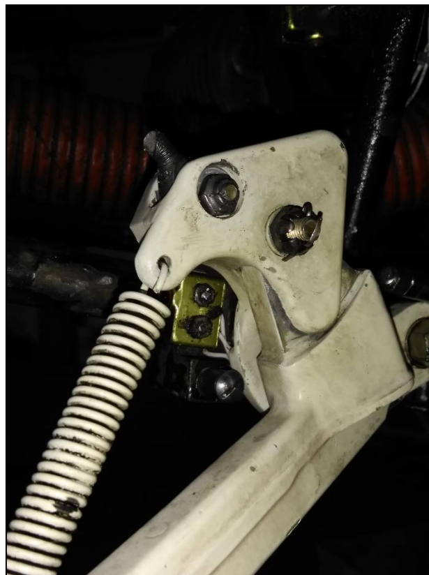
Figura 5. Traba de tren de aterrizaje instalada en el LV-LMG
