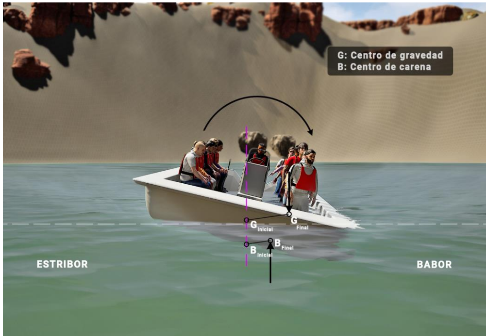
Figura 15. Las personas se ponen de pie y se corren desencadenando una escora y la posterior vuelta campana
