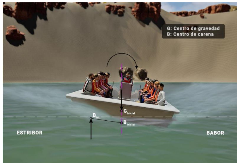
Figura 14. La embarcación se aproa desencadenando el embarque de agua por la proa
